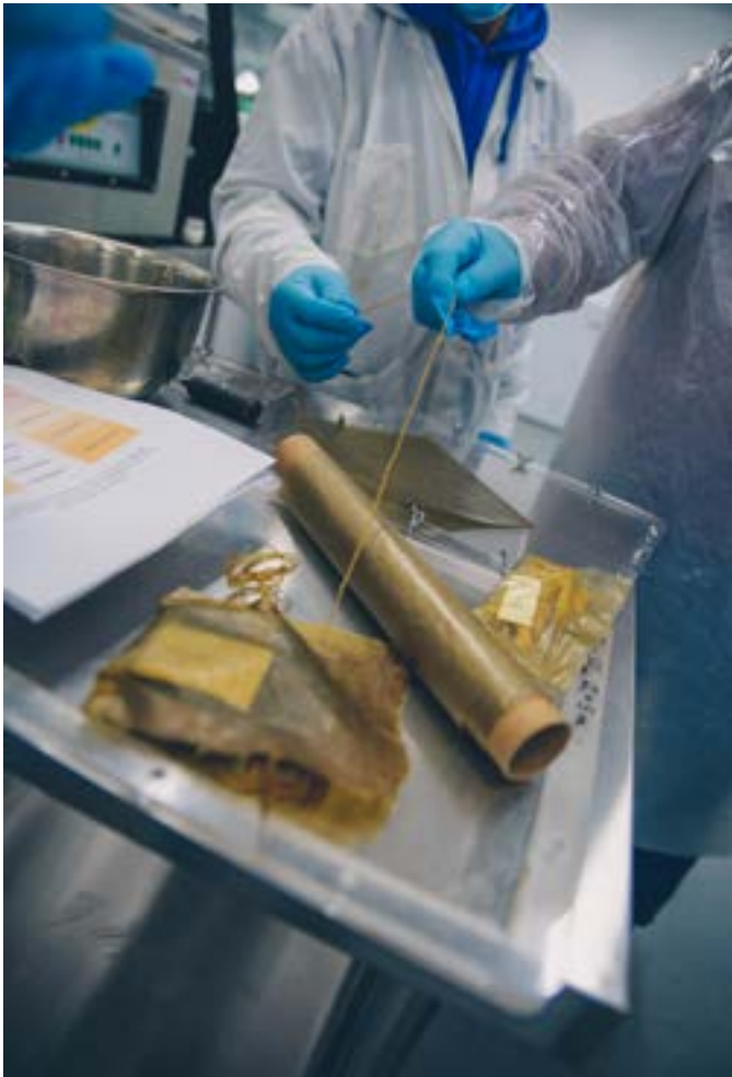
↑ Primeros prototipos de recetas de bioplásticos en base a alga Pelillo. Fuente: Tomás Vivanco.
