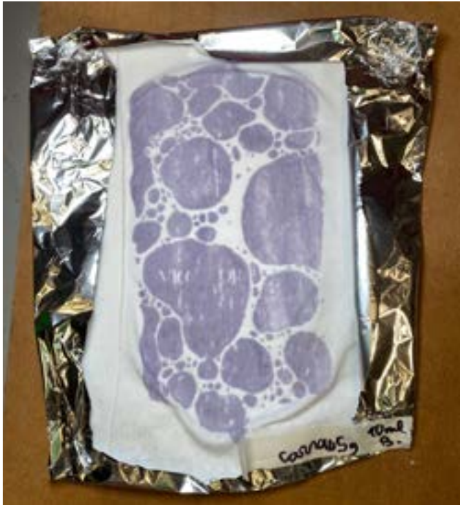
← Aplicación en poliamida a partir de pasta de estampación natural. Fuente: Lina Cárdenas
