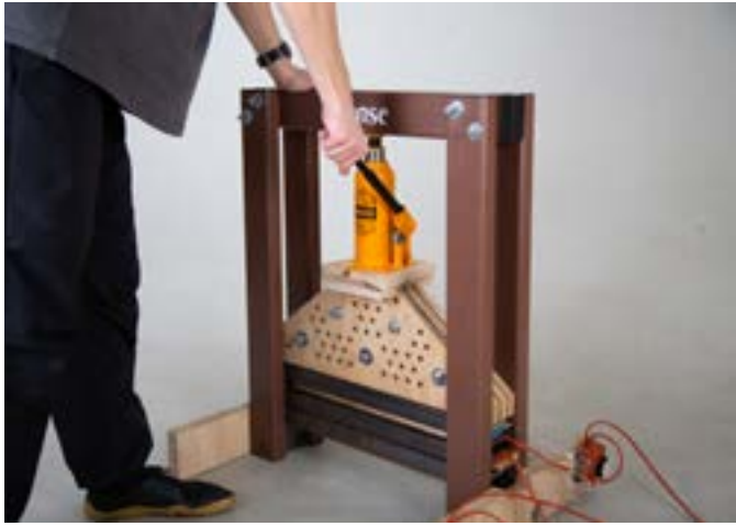
↑ Plataforma de densificación, utilizada para comprimir madera y estabilizar con calor. Fuente: Vicente Carmona.
