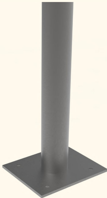
Imagen 70: Poste soldado a placa de anclaje Elaboración propia en conjunto con Álvaro Magalhaes
