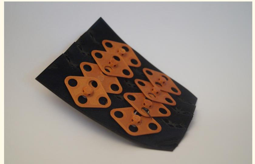
Para el desarrollo de este prototipo se experimentó con distintos tipos de filamentos de PLA y la implementación de una malla impresa en TPU (plástico flexible), esta última cumpliría el rol de ser una base estructural para las placas, además de contar con un patrón de cortes que permitirían una mayor expansión y zonas de aire para el vendaje.
