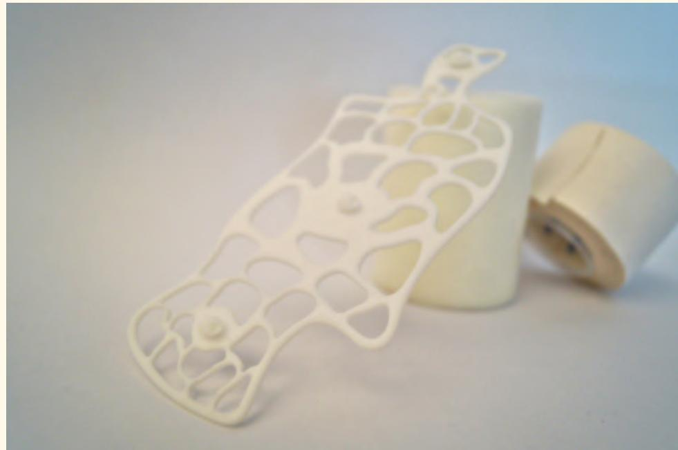
Durante la prueba de esta placa en conjunto con el sistema de compresión, se identificaron secciones que no se doblaban adecuadamente al aplicar presión. Para abordar este problema, se amplió el área de los extremos con el fin de minimizar el efecto de "bailar" de estas secciones. Además de esto, se llevó a cabo una reorganización en la disposición de los puntos de presión para lograr una distribución equitativa en todas las direcciones.
