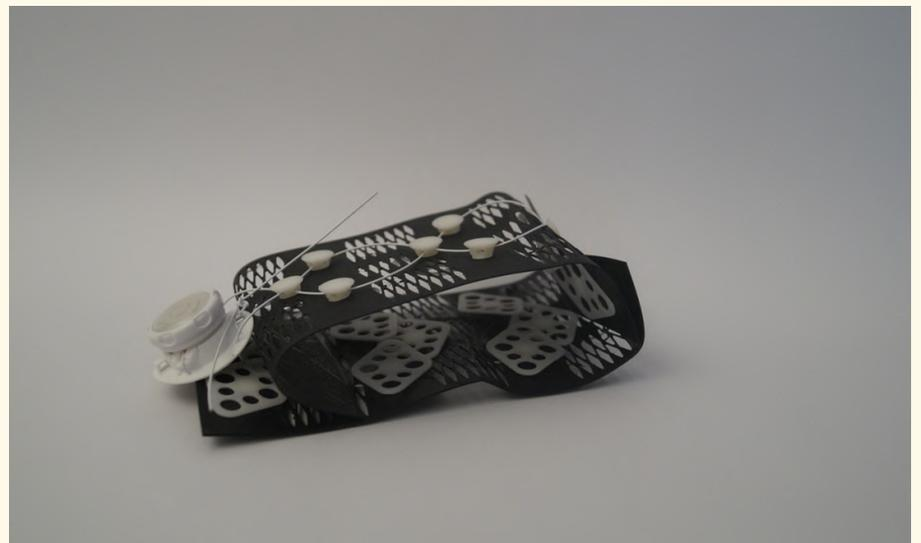
Durante una segunda fase de iteración se aumentó el tamaño de las placas y se testeó la unión de dos secciones para aumentar la estructura, y a su vez, la superficie de presión que estas generan. También se ampliaron los puntos de anclaje para el sistema BOA.
