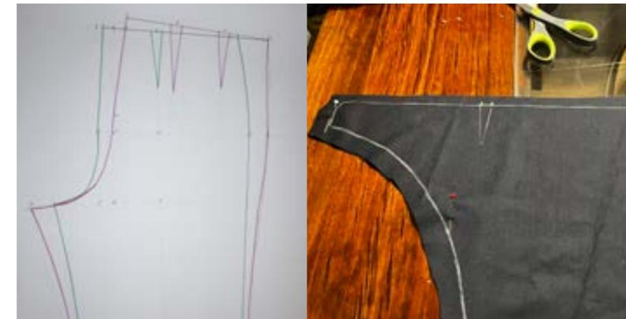
Con las **medidas de una mujer mayor talla 44**, se construyó un **molde base** de pantalón, que **luego se modificó según el diseño**. Este nuevo patrón se llevó a el prototipo número 1.
