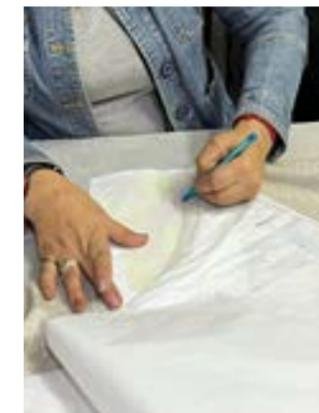
Se **arregló el molde** de pantalón según el testeó.
