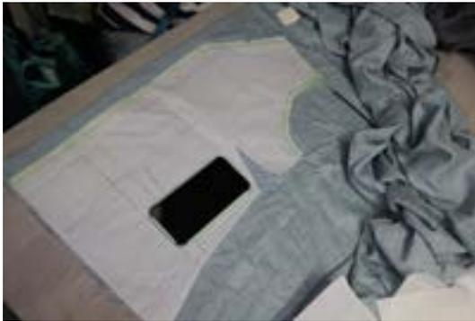
Se **agrandó** el molde. La tapa que va por debajo en la espalda, se hizo más ancha y se le eliminó la pinza, para lograr cerrar la espalda en la usuaria.
