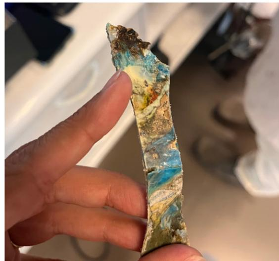
– Figura 33. Rotura ensayo de tracción
