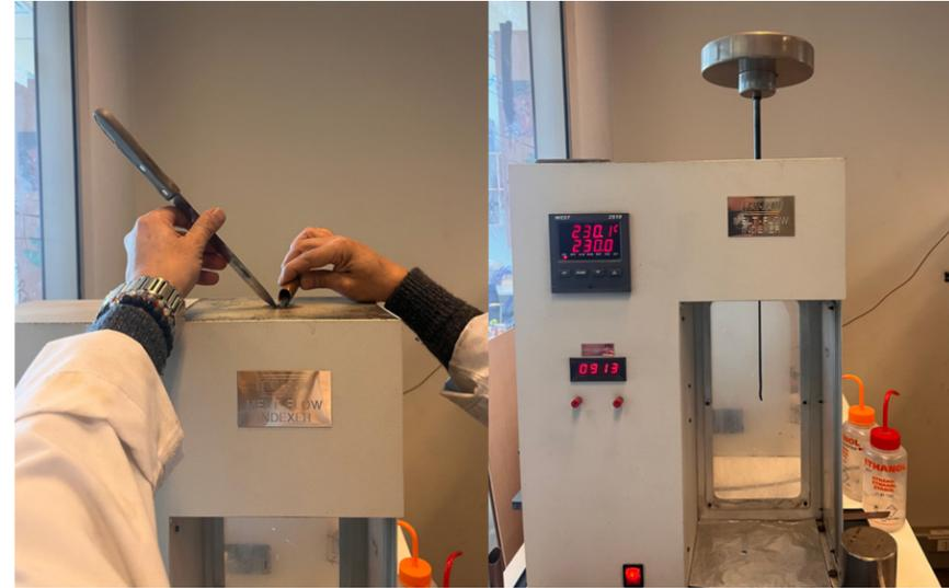
– Figura 80. Ensayo fluidez
