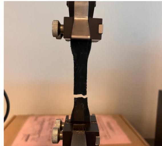
– Figura 77. Resultado final ensayo tracción.
