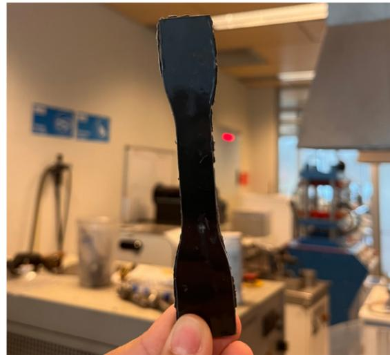
– Figura 76. Probeta para el ensayo tracción.
