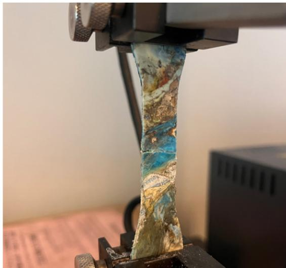
– Figura 32. Resultado ensayo de tracción
