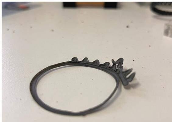
– **Figura 104.** Impresión mala, se levanta y se despegó.
