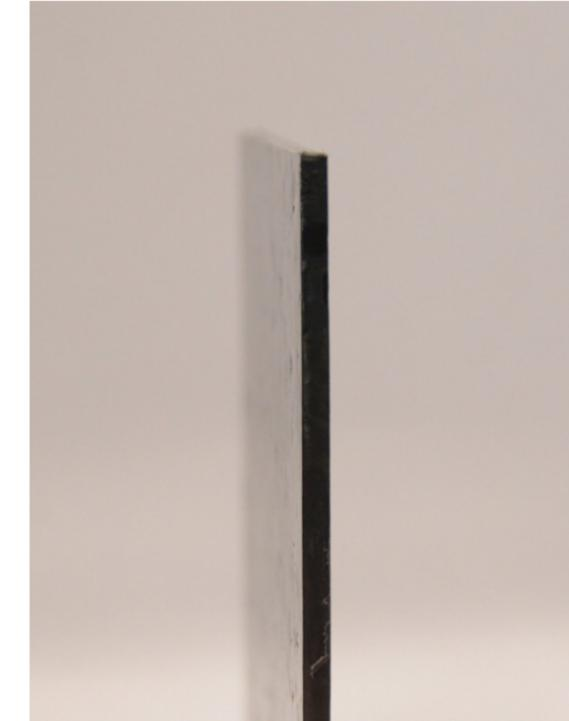
La muestra de 40 mm de ancho entrega buenos resultados, no hay giretas, ni burbujas, ni cambios de espesor. Sirven como revestimiento de cualquier tipo de mobiliaria e incluso para algunos productos con detalles más delgados.
