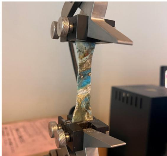
– Figura 31. Preparación del ensayo de tracción.
