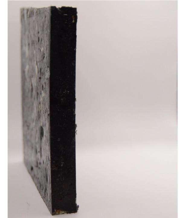
El espesor en exceso requiere de más precisión, además se concluye que es mejor realizarlo en un horno de compresión, ya que reparte el calor más uniforme que en la prensa, de esta forma se evitan los cambios de grosor y el calor se expande mejor. Las giretas en algo tan compacto y ancho, no son un índice negativo (mientras no sean en exceso no profundas). Por lo tanto, el material sigue siendo rígido, pero con peores terminaciones, lo que se debe iterar para mejorarlo.
