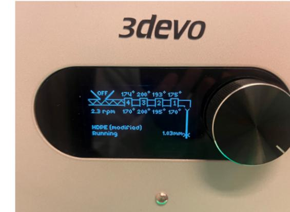
– Figura 97. Programación máquina para hacer filamento..
