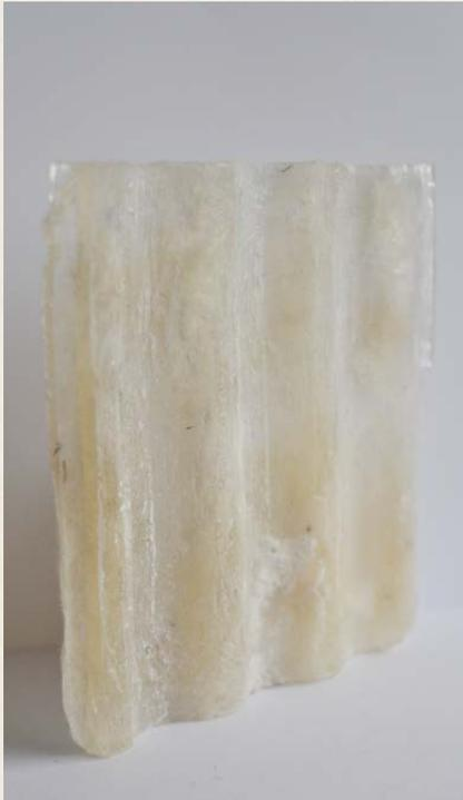
El testeo se enfocó en el diseño y uso del molde, el cual debía considerar los grosores mínimos para obtener una correcta aislación térmica y a su vez, mantener la relación de mezcla de ambos materiales para asegurar la funcionalidad. Se vertió la mezcla en un molde hecho de silicona de caucho, sin embargo se tuvo un bajo control del color del producto y del desmoldaje, ya que este se hizo sin la espera de un enfriamiento completo del material y dejó dispereja la superficie.
