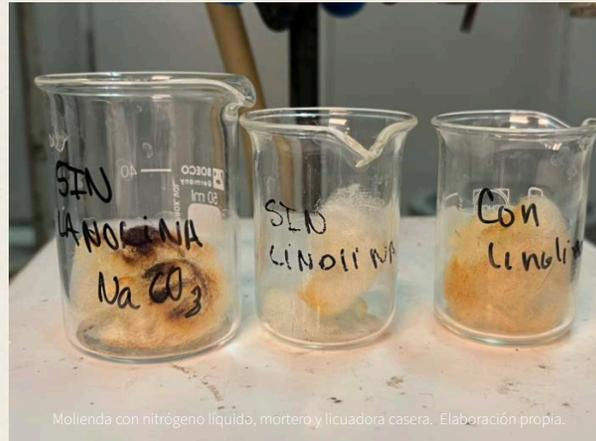
Molienda con nitrógeno líquido, mortera y licuadora casera. Elaboración propia.
