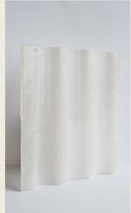
En el último testeo se obtuvo un resultado más homogéneo en cuanto a color y la compactad del producto. Los principales hallazgos fue que no se logró mantener una superficie 100% lisa, puesto que la lana al ser un material fibroso, tiende a sobresalir y esponjarse incluso bajo el trabajo de un aglutinante. Se tomó la decisión de sellar el revestimiento con una capa de 20 gramos de resina epóxica no tóxica, para asegurar una mayor durabilidad y evitar desprendimientos de lana.
