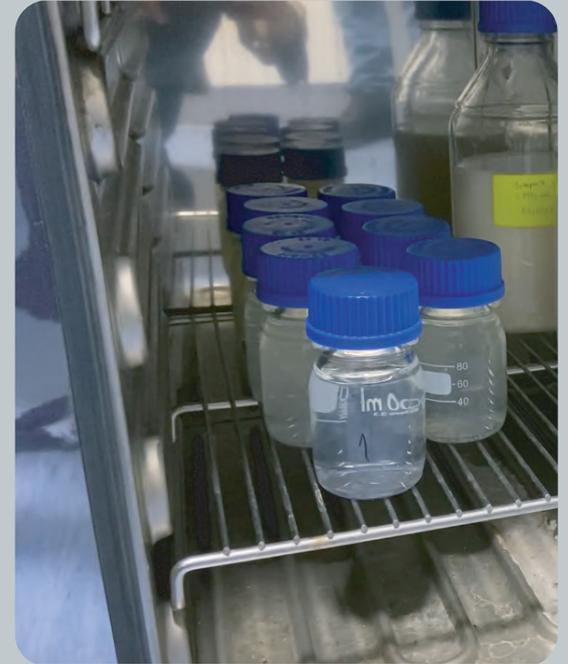
03. Aceleración por temperatura de muestra para revisión en tiempos estimados.
