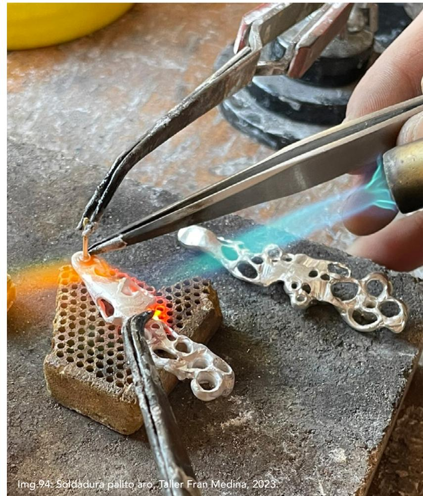
**4. Aplicación del metal de soldadura:** A medida que la zona de unión alcanza la temperatura adecuada, aplicar el metal de soldadura (en forma de varilla). El metal de soldadura debe fluir y unirse a las superficies de manera uniforme.
