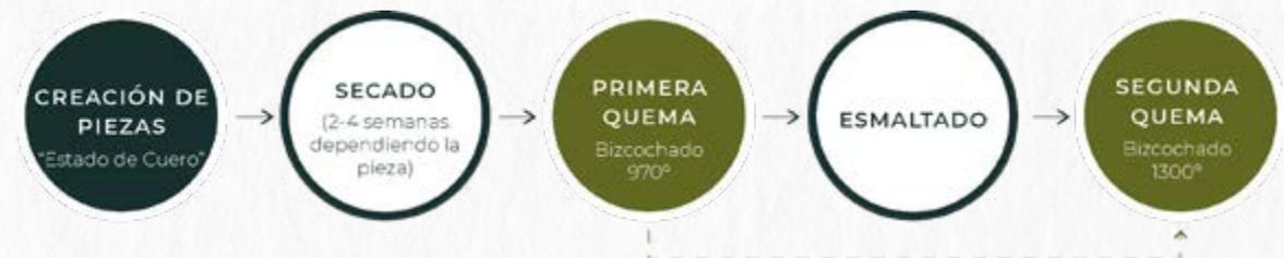
(Fig. 8. Esquema proceso de la cerámica gres, elaboración propia, en base a esquema en tesis Cuno)
