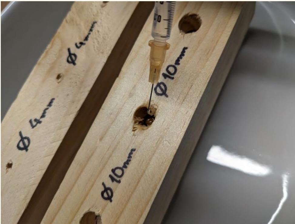
Probetas de ensayo hinchazón tarugo para retención mecánica.
