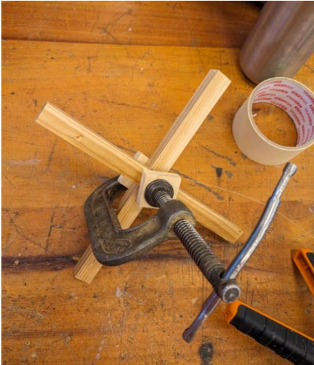
Se solucionó mediante un corte diagonal sutil que elimina el desfase de 4mm, este fue homologado a la punta de la pata trasera para mantener el detalle en armonía. Si bien era un pequeño desvío del aspecto ortogonal estaba apropiadamente contenido en el corazón de la silla y no competía ni forzaba a demás elementos a asimilarlo. Finalmente sirve como el único detalle constructivo que aporta interés visual por sobre la articulación de los demás elementos sin robarse el escenario.
