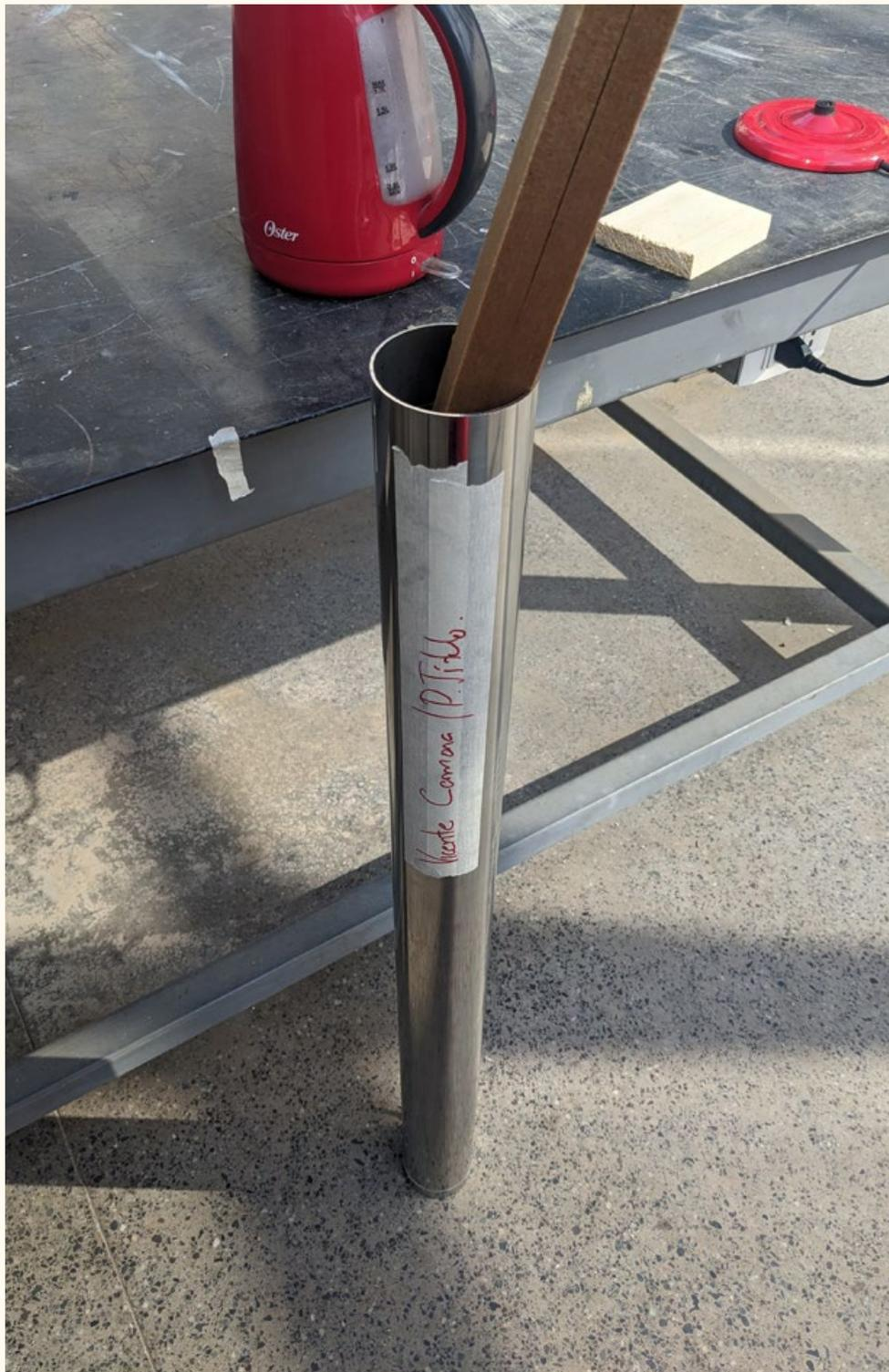
Se adquirió el tubo de acero inoxidable de un distribuidor de partes para autos, se tapó un extremo con terciado de abedul a presión asistido por una abrazadera y se sostuvieron las resistencias al exterior con amarras plásticas. El pivoteo de la PP se logró de forma expedita y con buenos resultados, no hubo problemas de fugas y tan solo se debió incorporar un contrapeso en la apertura superior para mantener el listón sumergido durante las dos horas de plastificación.
