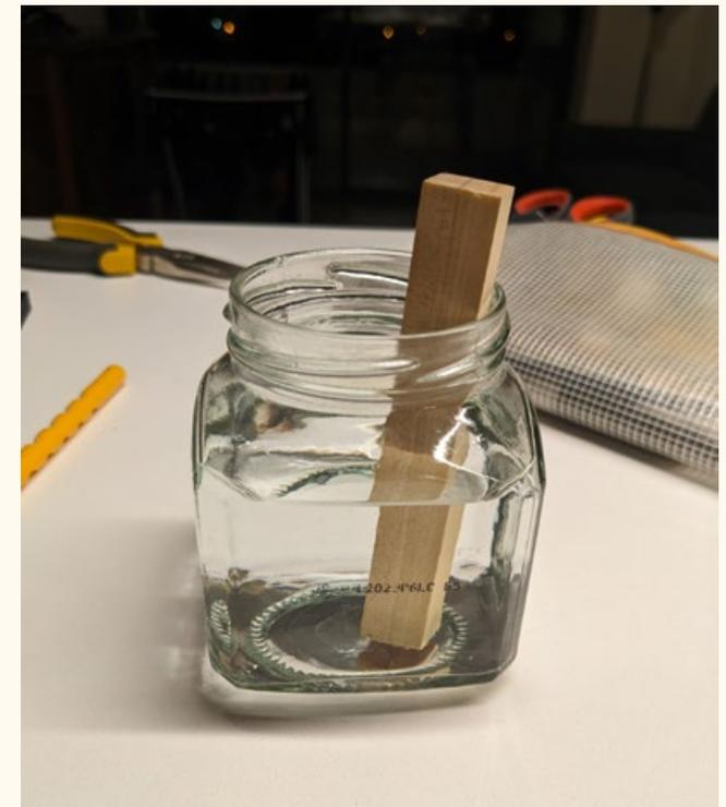
Evolución de la deformación de la madera densificada en el tiempo debido a inmersión parcial en agua, se llevó registro en: 30m, 60m, 120m, 24h, 48h y 14 días.
