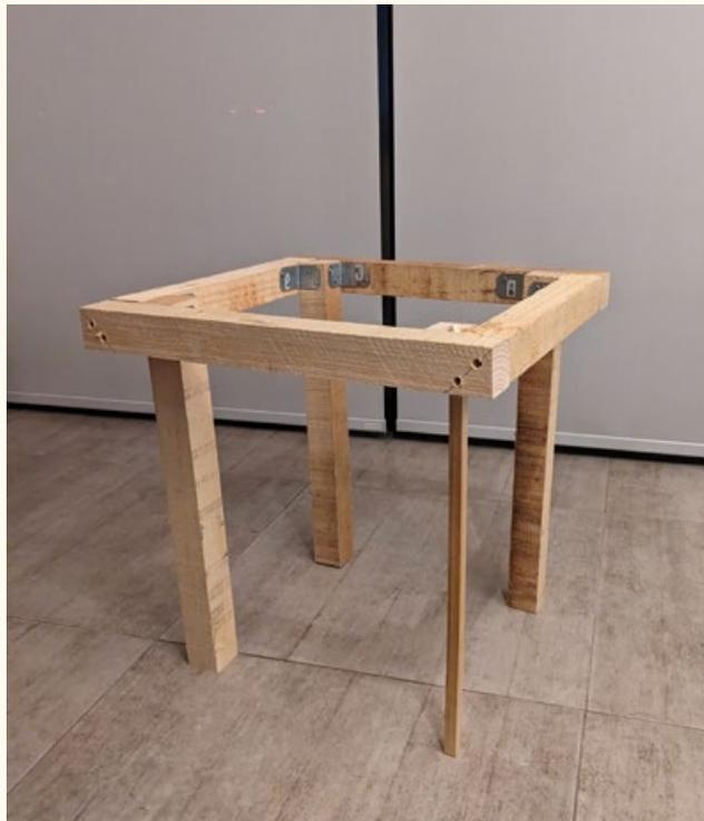
Marco elaborado para probar la resistencia de una pata de madera densificada de sección 16x16mm.
