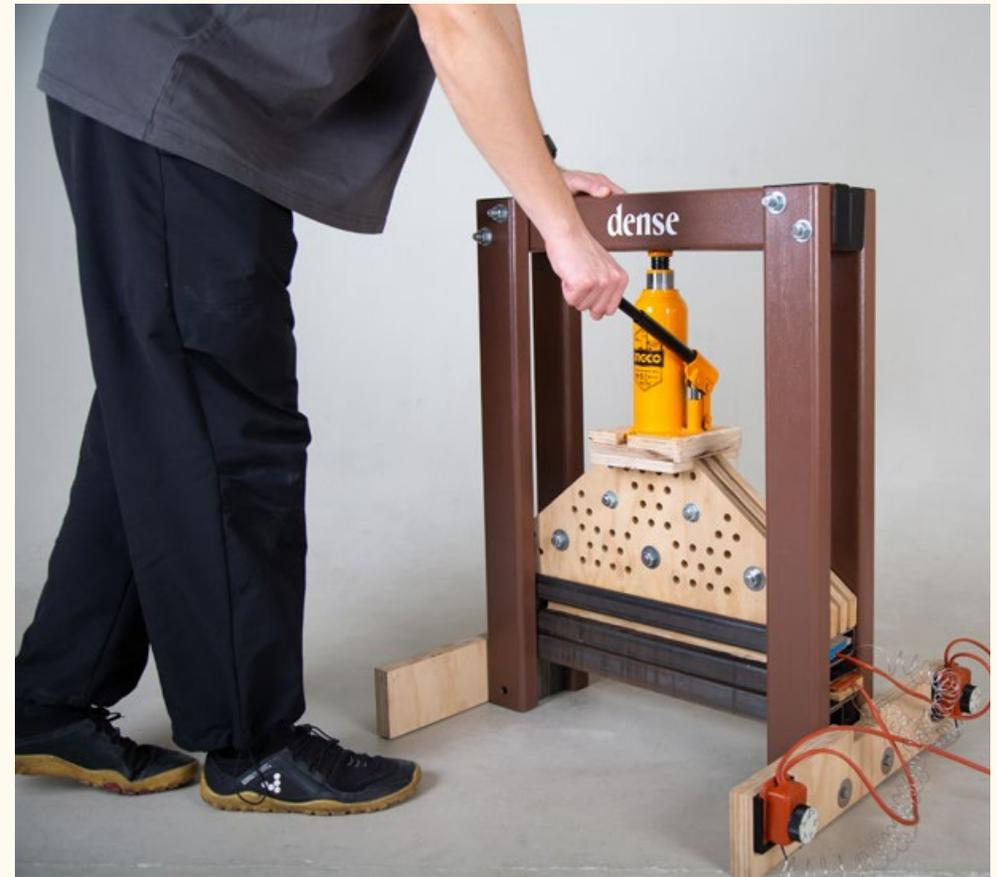
Flujo de uso de la plataforma de densificación: prender resistencias, ajustar gata, ingresar espécimen y comprimir hasta reducción de altura deseada.
