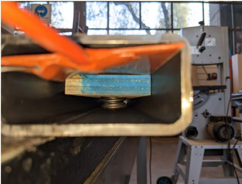
Se ideó una sistema con resortes para mantener la manta de silicona en contacto con la cara interior del perfil de acero, permite que sea removible facilmente y el terciado aísla el calor así se puede transmitir de forma eficiente a través de la cara deseada del acero.
