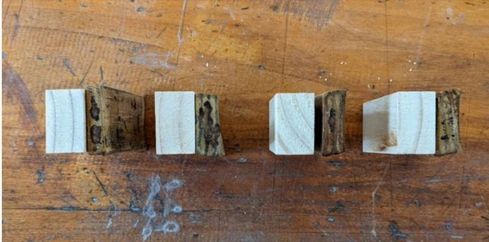
Resultó evidente que la técnica con que se produjeron las primeras probetas no se puede escalar a formatos más grandes de madera ni a un mayor volumen de muestras. Se requiere mayor fuerza de compresión que la que se puede lograr con prensas manuales o de banco, además esta compresión debe estar distribuida equitativamente para obtener un perfil de densificación estable e idealmente las mandíbulas que comprimen la madera, o el medio de densificación, debe ser capaz de calentarse.
