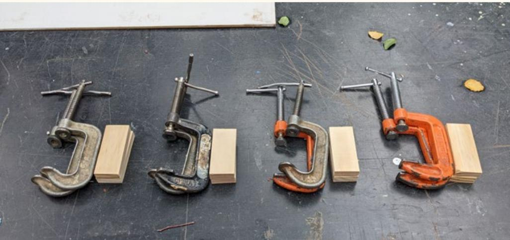
Se densificaron cuatro probetas de pino radiata utilizando simples implementos de cocina y luego prensas tipo C para reducir el volumen e ingresar las muestras prensadas a un horno. Fue importante aproximarse al trabajo práctico de densificación de forma temprana, ya que no solo permitió entrar en contacto físico con el material, sino que también enfrentar el desafío que significa densificar, en función de los instrumentos necesarios para hacerlo.
