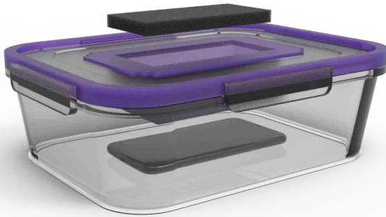
Dentro contenedor, se colocó un teléfono móvil con una aplicación especializada en la medición de decibeles, lo que permitió realizar mediciones precisas de los niveles de ruido en el interior del contenedor.
