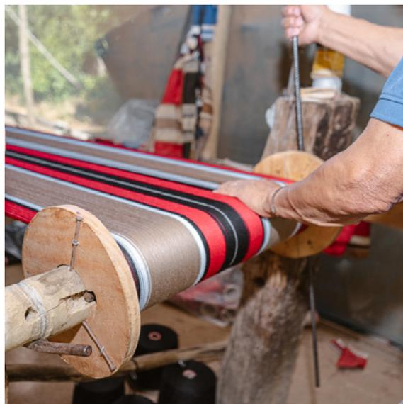
*“El hilado se trabaja en densidad por centímetro, de aproximadamente 16 hilos dobles en urdimbre y 7 hilos simples en trama, lo que da una densidad y textura acartonada, requerida para la buena caída de la manta” (Günther, 2009).*
