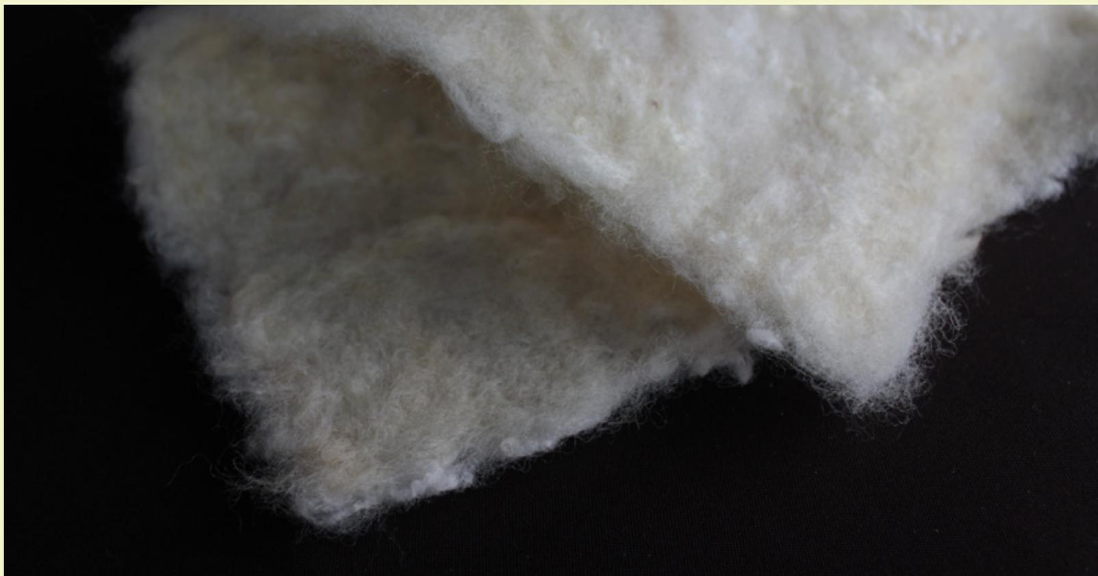
Figura 48: Detalle fieltro agujado de lana lavada
