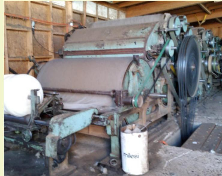
Figura 54: Proceso de limpieza de la lana
