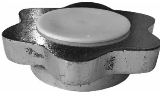
Prototipo rápido de mecanismo de pesos intercambiable. (2022).
