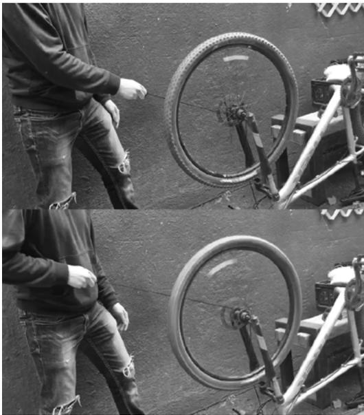
Prototipo rápido de mecanismo de volante de inercia. (2022).
