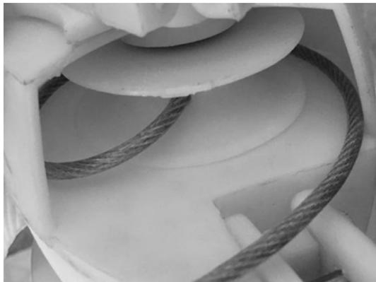
Piola de acero trenzado topando con las paredes del mecanismo. (2022). Elaboración propia.
