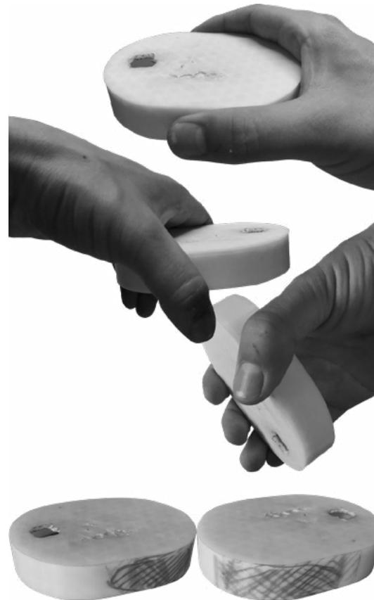
Manipulación de la geometría base y rayado de puntos principales de contacto. (2022). Elaboración propia.
