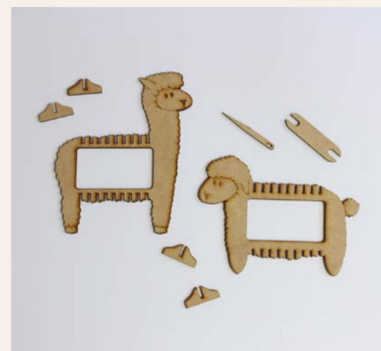
Fig 100: Primer diseño telares y accesorios impresos en láser (material: MDF). Fotografía propia.
