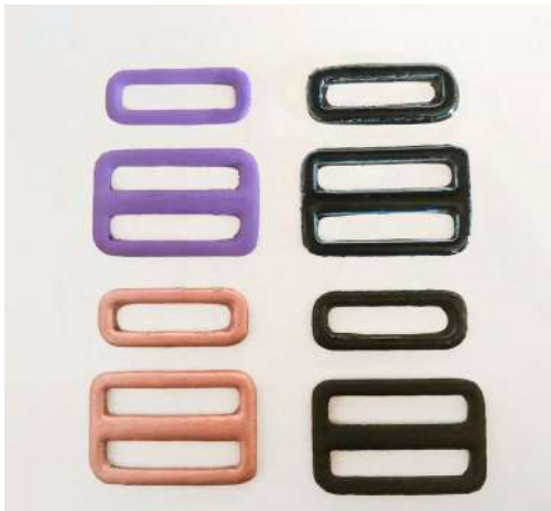
Figura 111: Pasadores impresos en 3D y pintados. Imagen de elaboración propia
