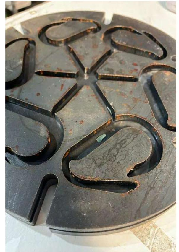
Figura 78. Molde de Sinestesia para inyectora
