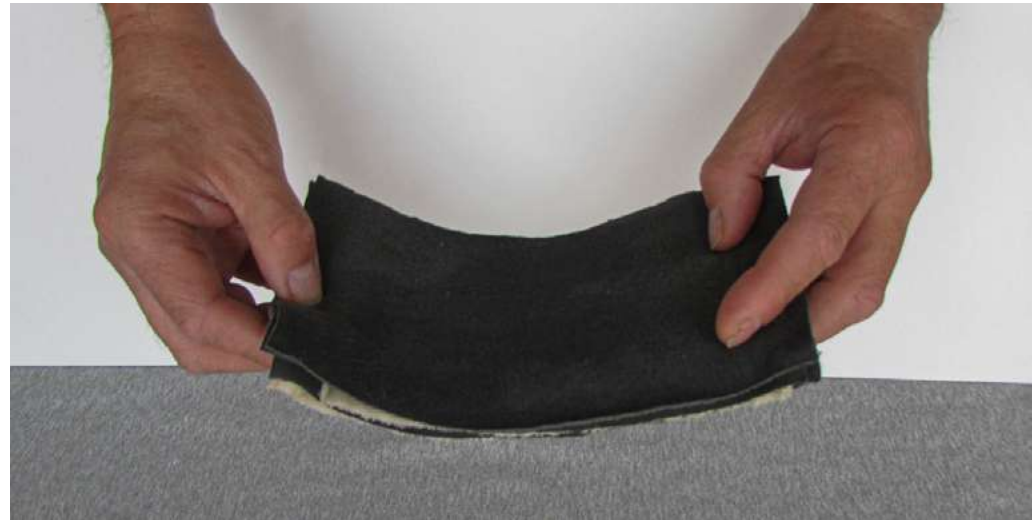
Prueba de doblez realizada con 6 capas y 80 ml de líquido
