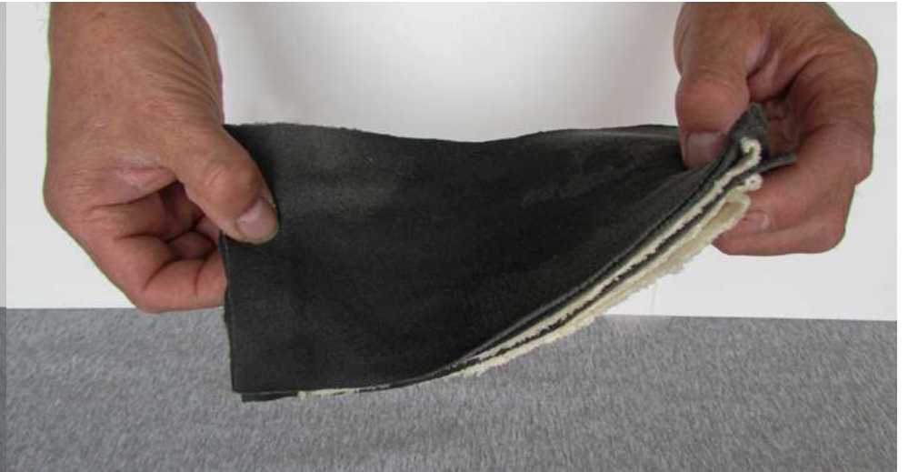
Prueba de doblez realizada con 6 capas y 80 ml de líquido
