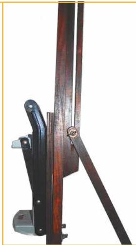
Sistema de regulación del ángulo de la estructura.
