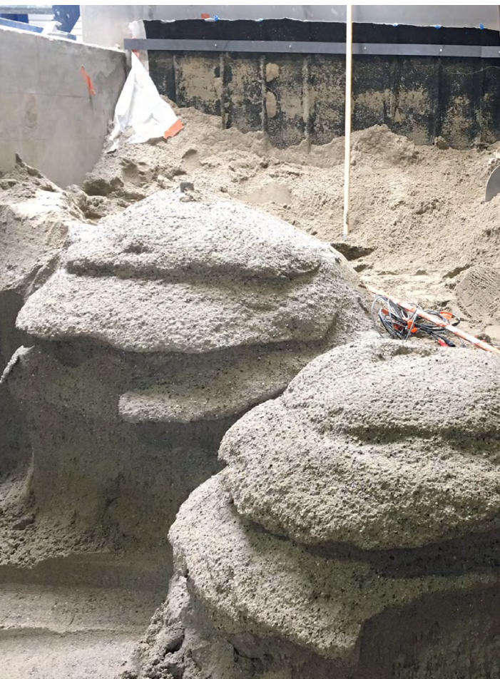
Fig. 14: Cementación de suelos utilizando S. pasteurii , aplicada por la empresa Solentache Bachy (Esnault-Filet, 2019).
