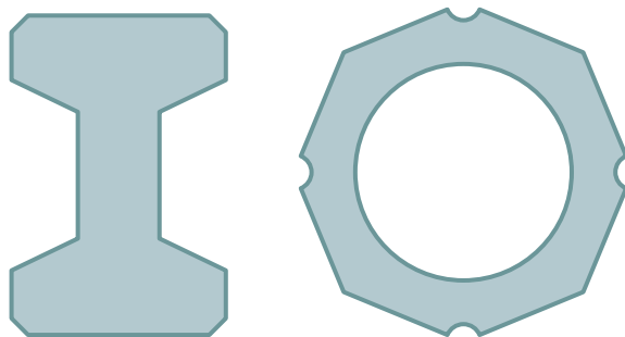
Fig. 44: Comparación de las secciones de ambos postes, evidenciando un cambio de perímetro en el exterior.
