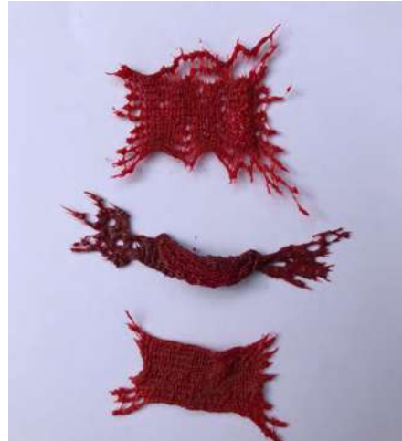
Muestras cuadradas de contenedores extruido, envase liso y tejido sobre bandeja de silicona a 150°C por 20 minutos. Elaboración propia.
