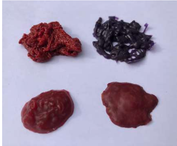
Resultados de 20 minutos al horno a 200°C, de izquierda a derecha y de arriba hacia abajo, corresponden a muestras de contenedores tejido, tubular diamante, extruido y liso. Elaboración propia.
