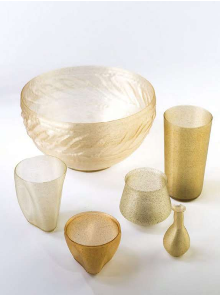
Iniciativas como este proyecto que utiliza un biomaterial en base a algas para imprimir en 3D y crear productos biodegradables que eventualmente puedan reemplazar el uso de plástico. Morris, A. , 2022.
