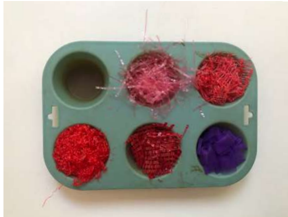
Muestras previas a la entrada del horno en una bandeja de silicona. De izquierda a derecha y arriba hacia abajo corresponden a los contenedores envase liso, tejido, un contenedor que se descartó de seguir testeando, extruido y tubular diamante. Elaboración propia.
