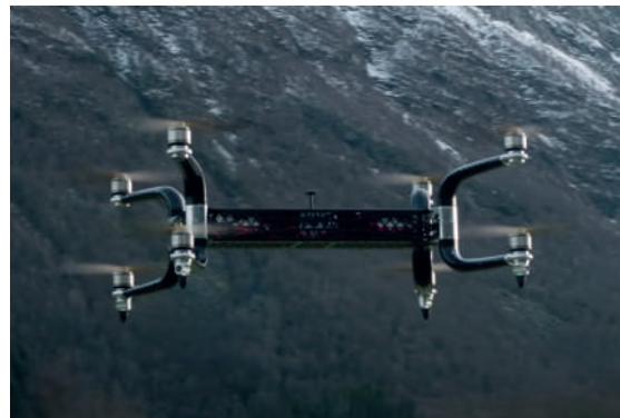
Drone Driff 300 levanta hasta 225 kilogramos creado por Griff Aviation
