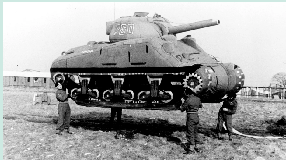
Figura 23: Un tanque señuelo hecho de caucho en 1939. Recuperado del libro: The Ghost Army of World War II : how one top-secret
