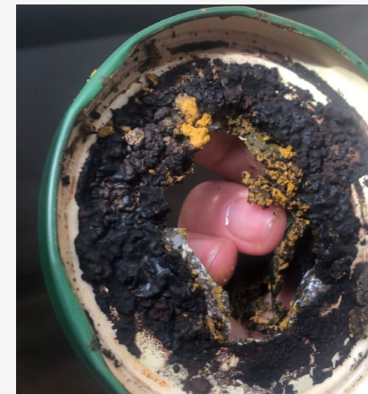
Tapa de frasco que almacenó por un año Celulosa Bacteriana de Kombucha, que demuestra los efectos del ácido acético en el metal.
