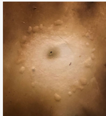
Peróxido de hidrógeno rociado en una mancha de óxido.
