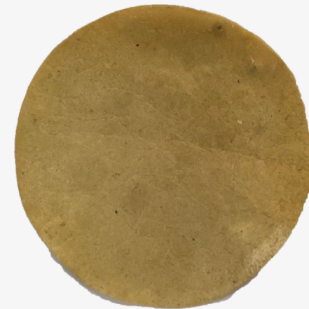
Muestra que solía tener manchas de óxido y fue rociada en su totalidad con peróxido de hidrógeno.
