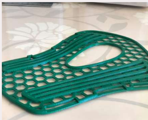
Impresión 3D de férula para probar su funcionalidad
