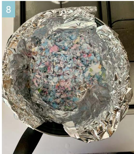
• La imagen 8 muestra el resultado luego de estar 20 minutos más a baño maría con tapa, tampoco logrando derretirse nada del material.
