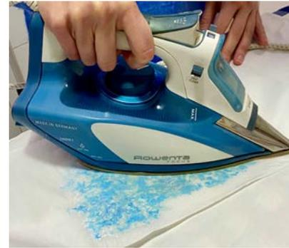
Luego, se puso una porción del material entre dos hojas de papel mantequilla y se le aplicó calor con una plancha durante 3 minutos.
