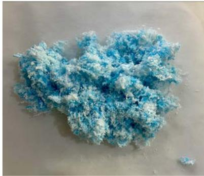
Primero, en una procesadora 1,2,3 Moulinex, se molieron 10 mascarillas sin elásticos y sin alambre fijador hasta que estuvieran completamente desintegradas.
