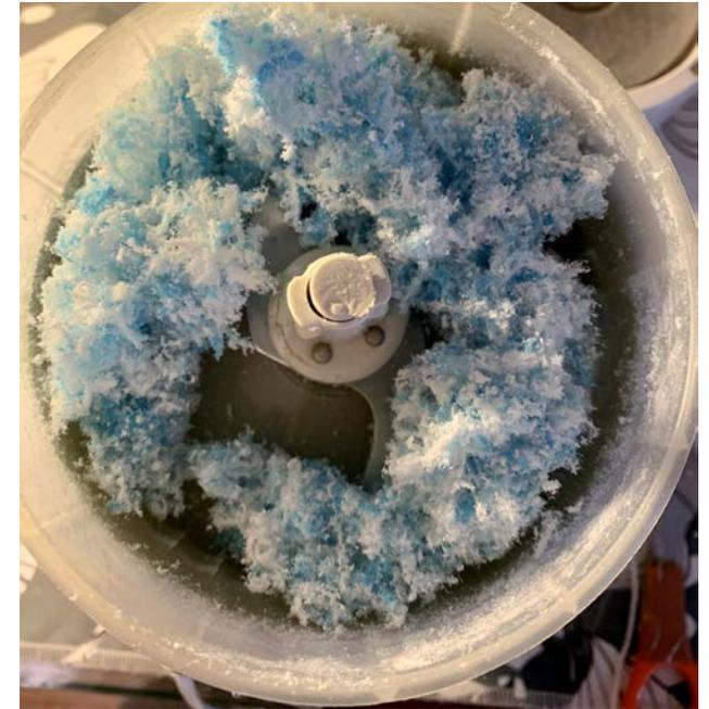
Proceso de molido de mascarillas que se usó durante casi todo el semestre para la experimentación antes de tener acceso a Sinestesia FabLab.
