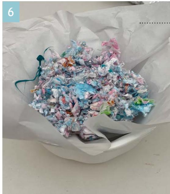
Resultado del material, luego de estar 15 minutos expuesto al calor de un horno microondas. Se puede ver que no alcanzó la temperatura suficiente para poder fundirse.
