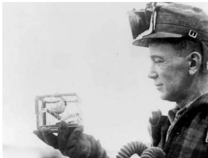
Imagen 18. Canario utilizado en tests de monitoreo de CO.
