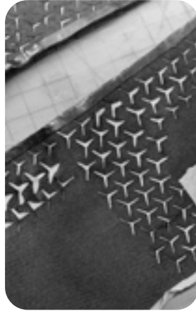
Sistema de expansión fijo con masking tape (Fig. 157). Elaboración propia.
