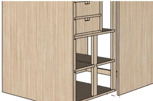
En el caso del Módulo 2, se removió la parte posterior de la "caja" base, agregando dos listones en la parte inferior para soporte, quedando solo los lados y el techo conformado de planchas.
