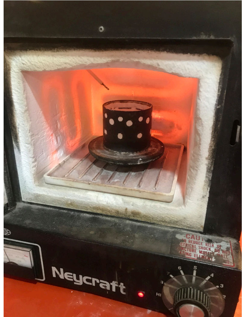
Horno a alta temperatura fundiendo la resina Fuente: Registro Personal
