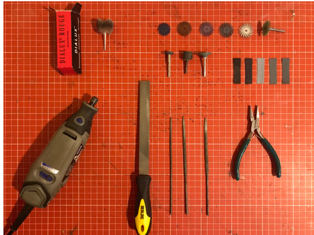
Herramientas y materiales para el proceso de lijado y pulido Fuente: Registro Personal
