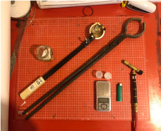
Materiales para el proceso de la cera perdida Fuente: Registro Personal
