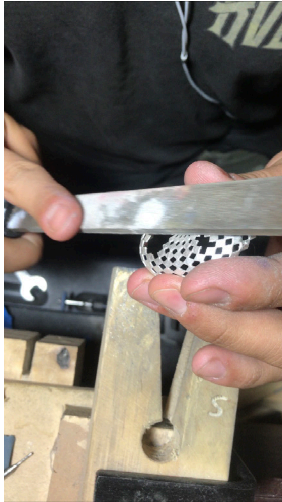
Puliendo y desvastando "Geopattern" Fuente: Registro Personal
