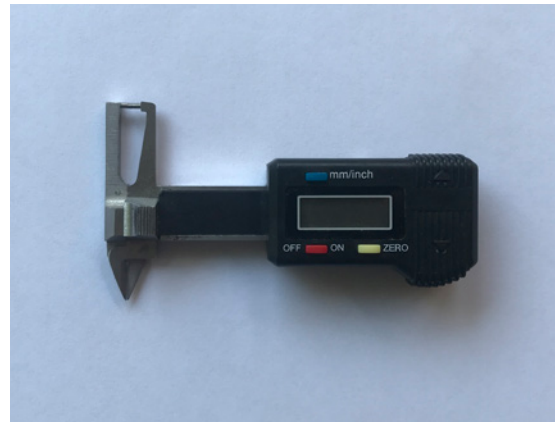
Pie de metro digital para medidas pequeñas de alta precisión Fuente: Registro personal
