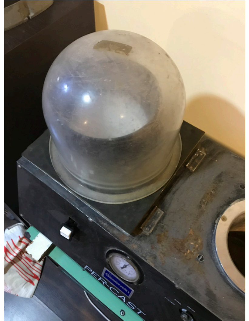
Proceso de extracción de aire mediante bomba de vacío Fuente: Registro Personal
