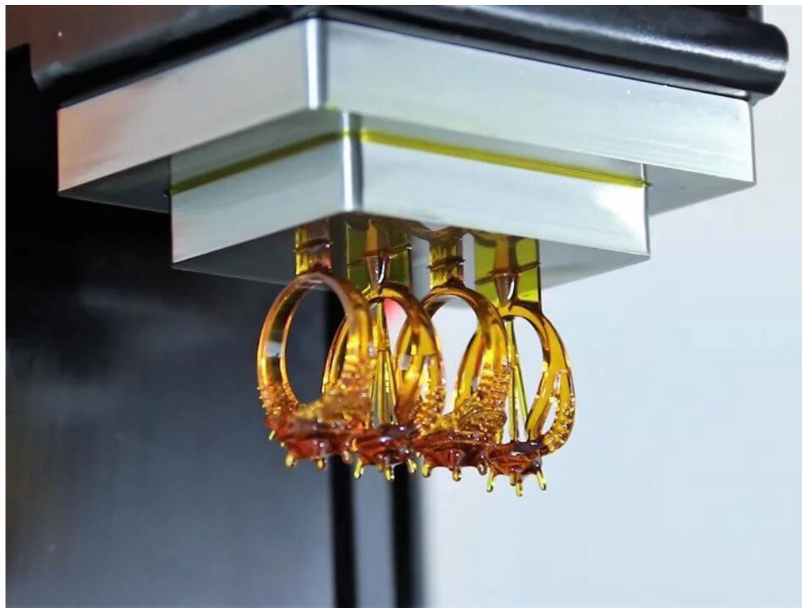
"Impresión 3D de anillos con resina" Fuente: www.all3dp.com
