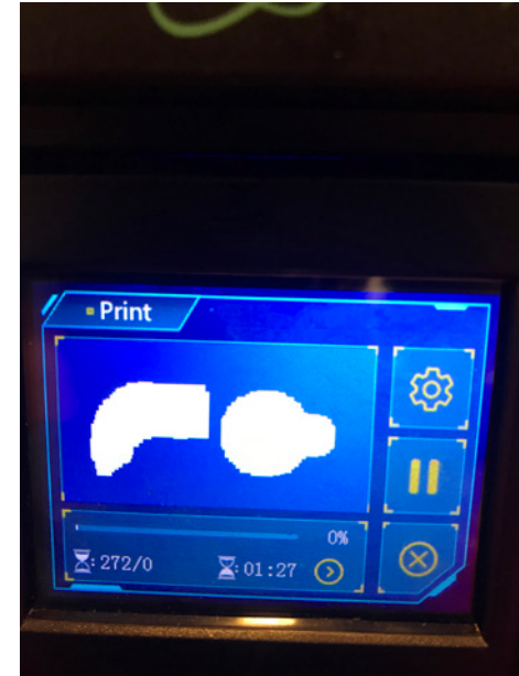
Display de la impresora donde muestra las capas restantes y el tiempo Fuente: Registro Personal
