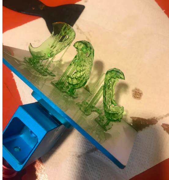
Despegar la pieza de la plataforma de construcción Fuente: Registro Personal
