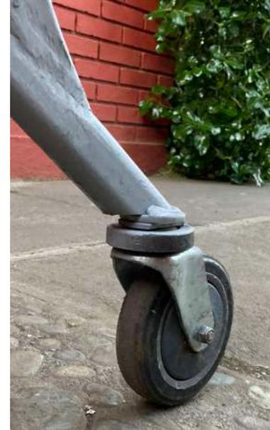
*Ruedas de 125 cm. de diámetro y 3 cm. de ancho. Las ruedas delanteras rotan dando dirección al movimiento de traslado.*
