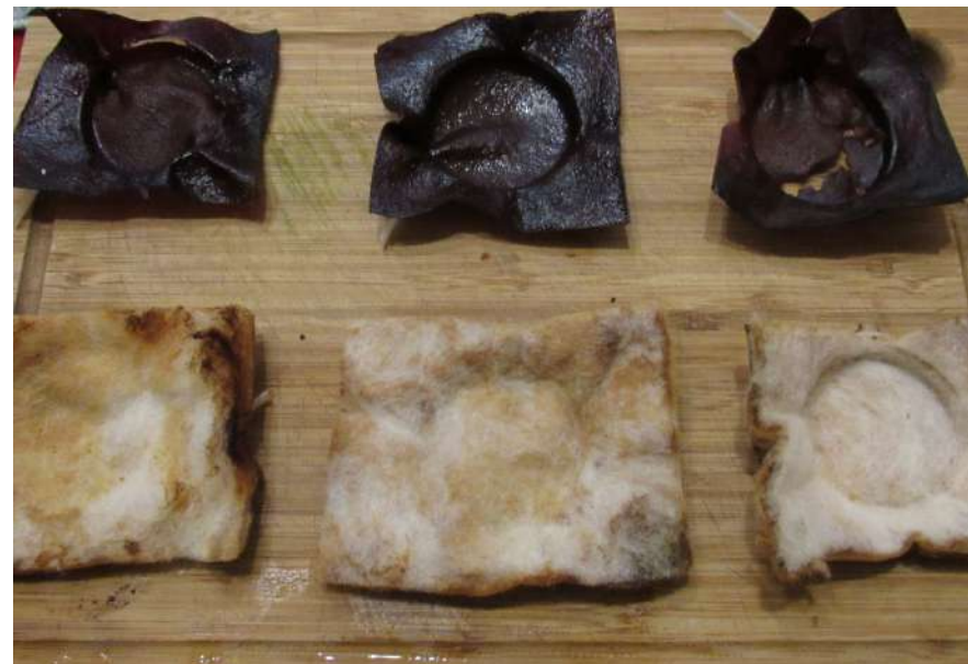
Vista piel resultado Test de Permeabilidad. Fotografía de Atoña Propia.
