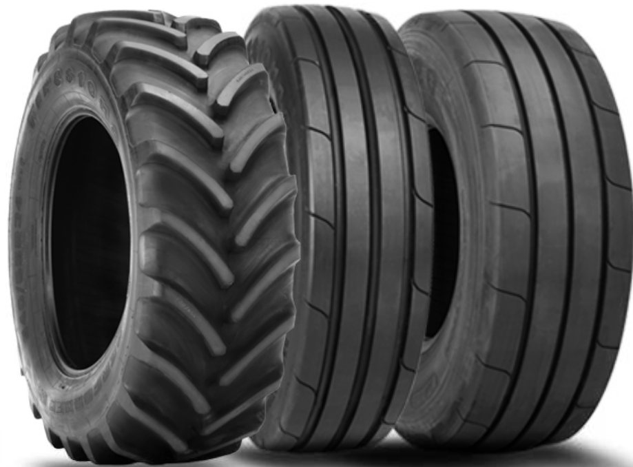
Imágen de la izquierda neumático diagonal y los de la derecha radiales.
