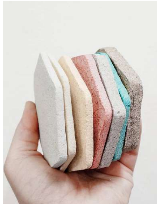
Fig.7 Biocompuesto de cascaras de huevos y conchas de mejillones, Fotografía de Labva
