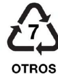
Figura 15 Ícono de código identificación de la resina número 7 otros. Compuesto por diferentes tipos de plásticos.
