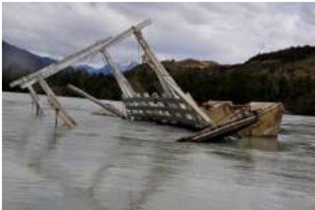
Figura 19: Fallo de el casco de flotabilidad de la Balsa Baker, Sector El Manzano (2014).
