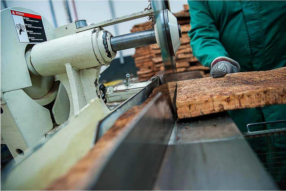
Operador de la fábrica cortando las planchas de corcho ya secas para elaborar tapones.
