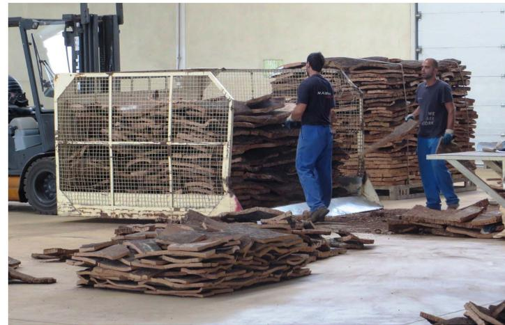
Después del hervido o cocido, el corcho debe pasar por un período de estabilización (de 2 a 4 semanas), durante el cuál se aplanan las planchas y se secan hasta alcanzar la consistencia adecuada para el recorte. Este reposo se efectúa en un local denominado bodega, que debe estar limpio, ventilado, y libre de olores que pueden incorporarse al corcho.
