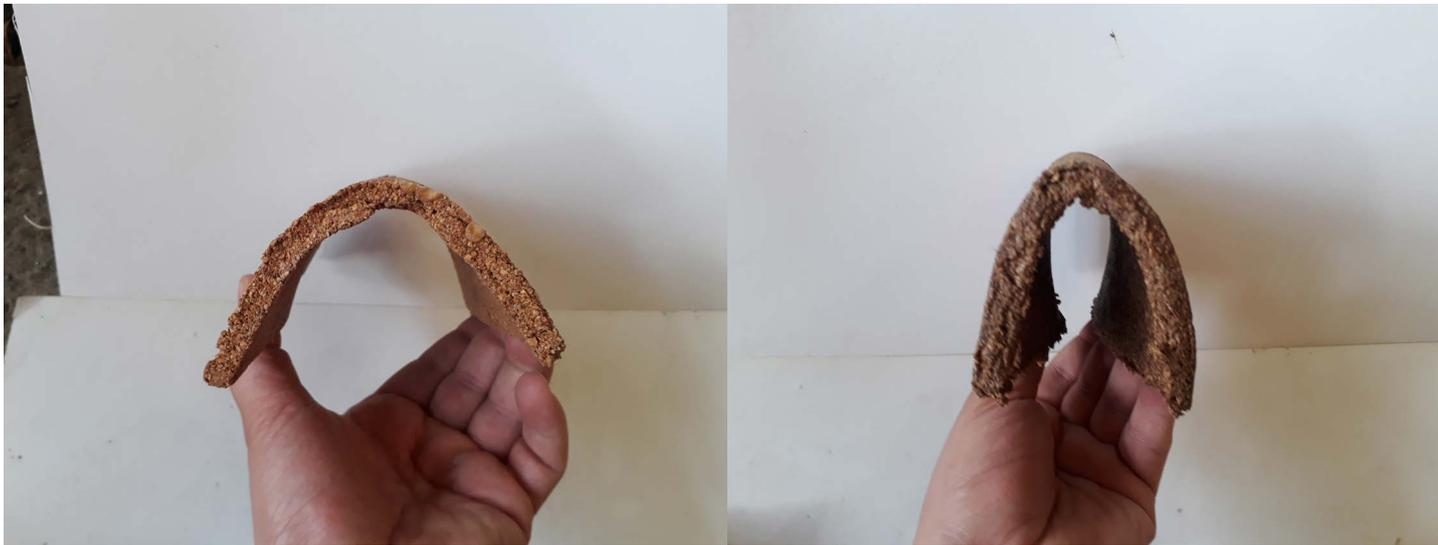
Comparación entre la elasticidad de la plancha de poliuretano (izquierda) y la de látex (izquierda).
