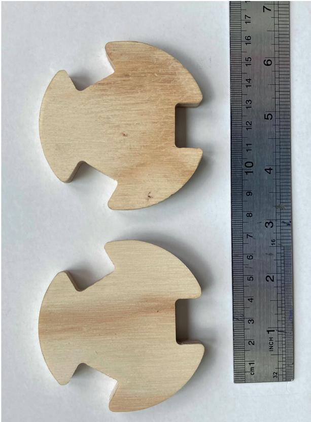
Los nodos constructivos se fabricaron a partir de corte por router CNC.
