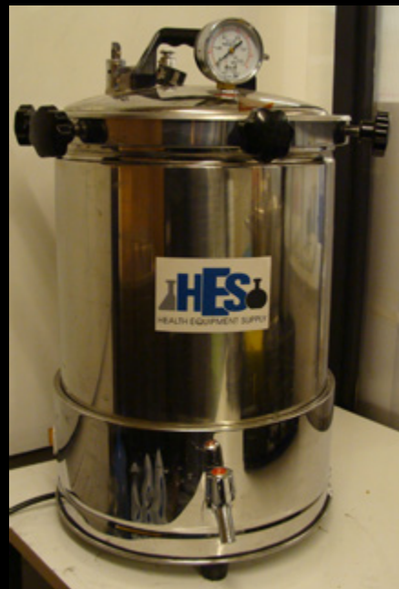
AUTOCLAVE Autoclave vertical con capacidad para 24 litros, con temperatura ajustable de 121°C o 126°C y una presión de trabajo de 0.142Mpa. Fabricado en acero inoxidable con una tubería eléctrica de calefacción y un anillo de sellado de caucho (silicona).
