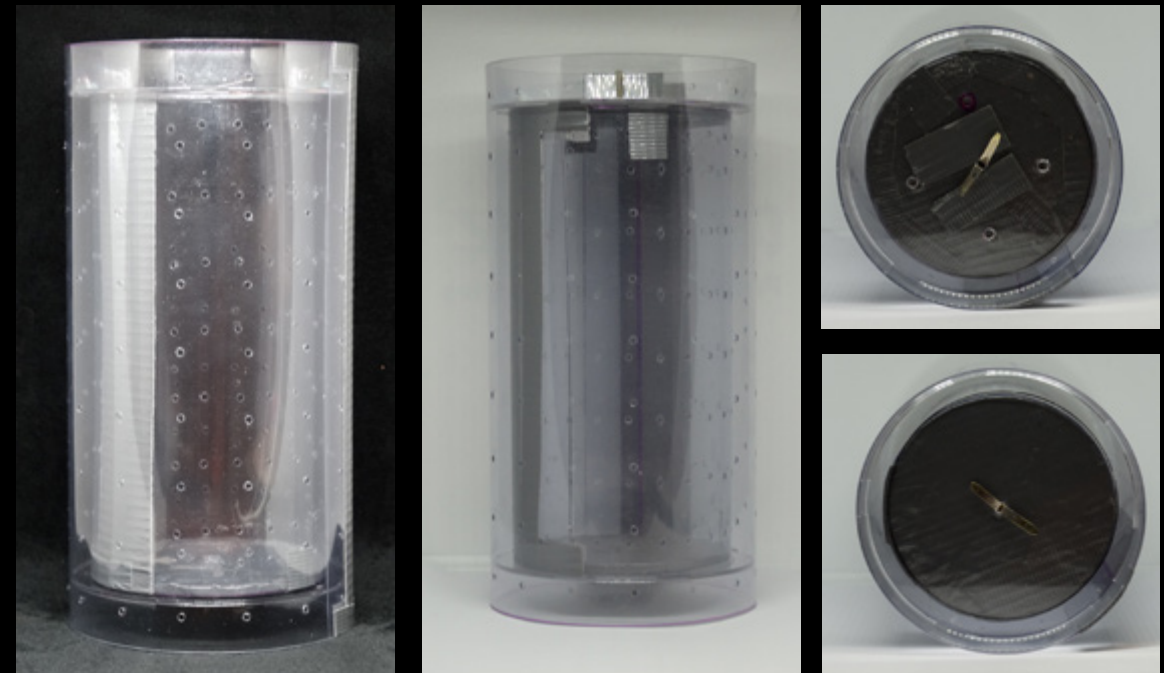
Molde construido con láminas de mica transparente, placas de petri plásticas, cartón piedra, broches 3/4 y cinta adhesiva duct tape.
