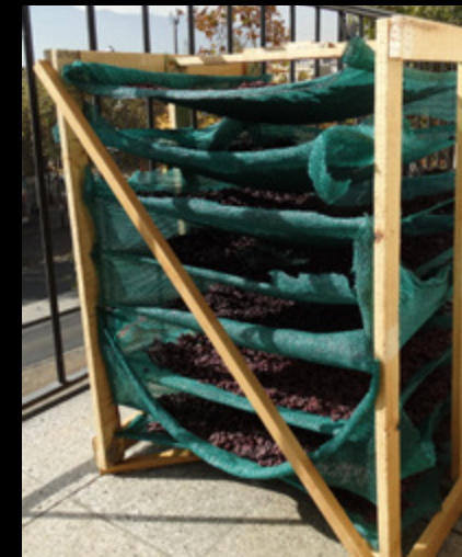
Orujos sobre malla dentro de estructura de madera (exterior)
