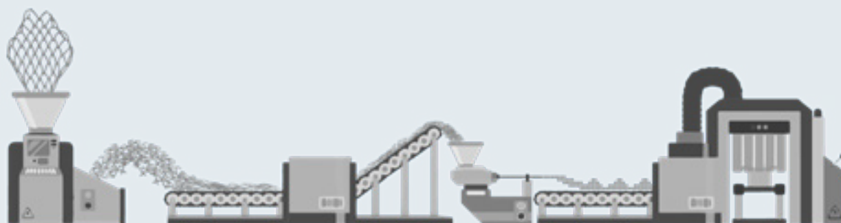
LÍNEA DE RECICLAJE MECÁNICO Y PELETIZACIÓN DE REDES DE PESA EN DESUSO, ELABORACIÓN PROPIA.
