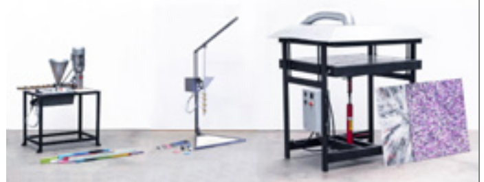
MAQUINAS INYECTORA, EXTRUSORA Y HORNO COMPRESOR DE LA EMPRESA PRECIOUS PLASTICS .
