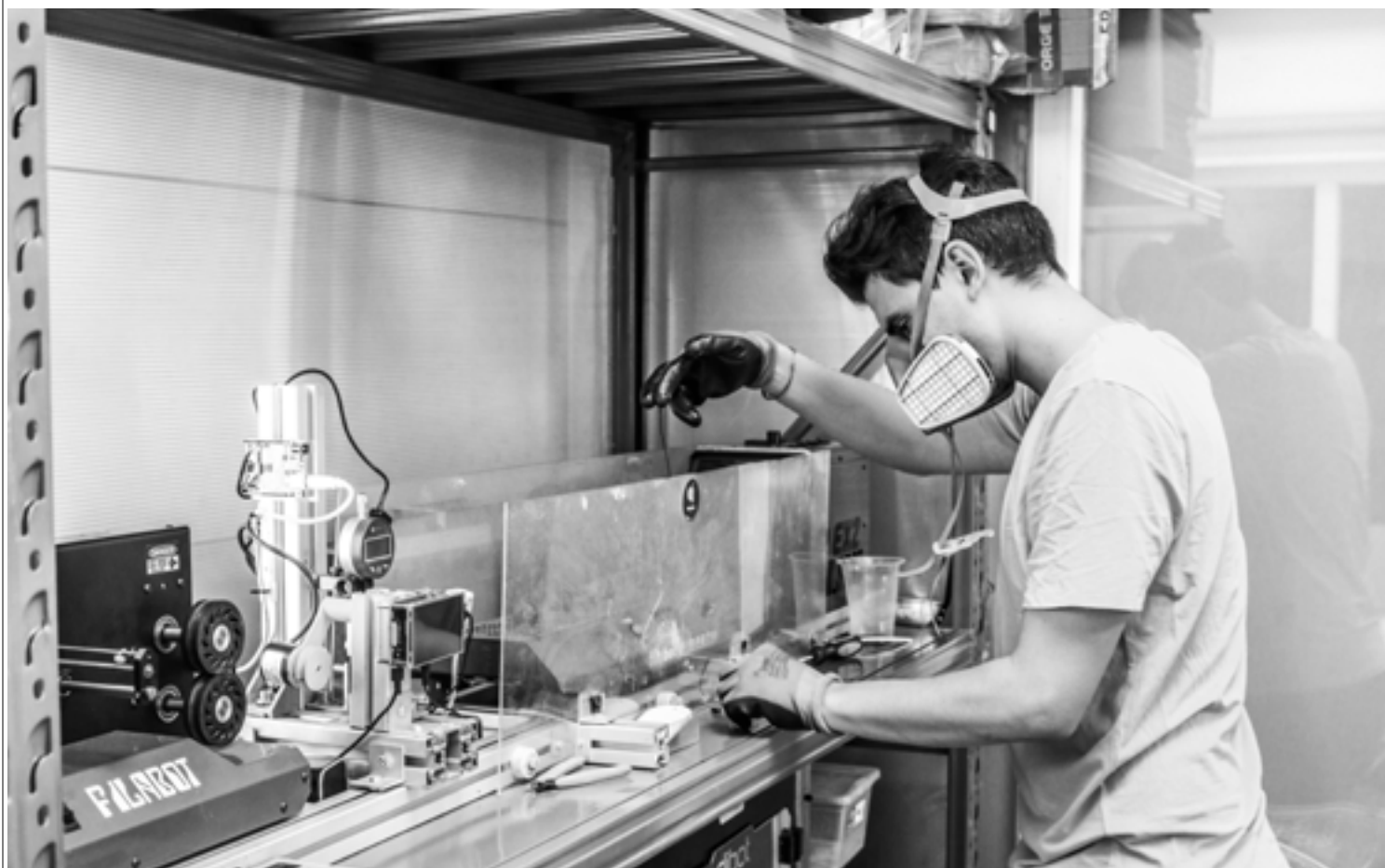
FELIPE HERBAGE REALIZANDO LA EXTRUSION DE PELLETS DE NYLON 66 RECICLADO, ELABORACIÓN PROPIA.
