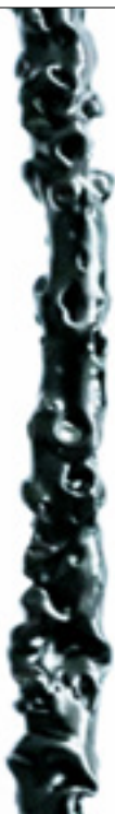
EXTRUSION DE PELLETS DE NYLON 66 DE AMBOS TIPOS DE RECICLADO, ELABORACIÓN PROPIA.
