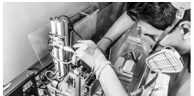
FELIPE HERBAGE CALIBRANDO LA EXTRUSIÓN DEL FILAMENTO, ELABORACIÓN PROPIA.
