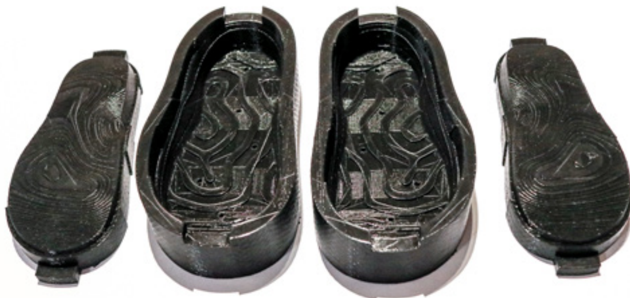
MOLDES IMPRESOS EN 3D PARA SUELAS N.F.U., ELABORACIÓN PROPIA.
