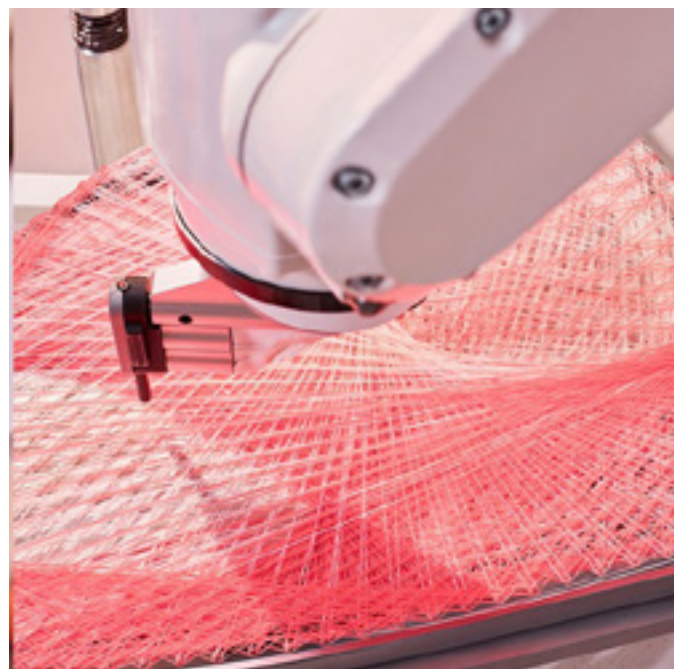
ROBOT "STRUNG" FABRICA LA PARTE SUPERIOR DE UNA ZAPATILLA, ADIDAS, 2020.
