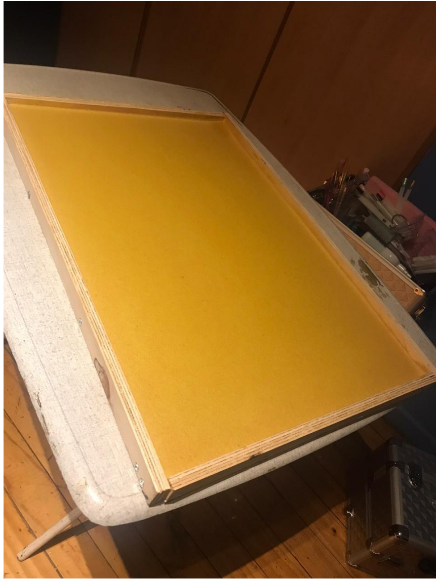
Fig. 32: Mezcla recién vertida en el molde. Elaboración Propia.
