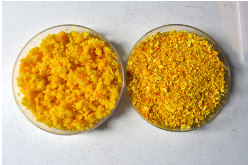
Fig. 27: Procesamientos de la materia prima. Izquierda: cáscaras de naranja trituradas en bruto. Derecha: cáscaras de naranjas deshidratadas y luego trituradas en la licuadora.
