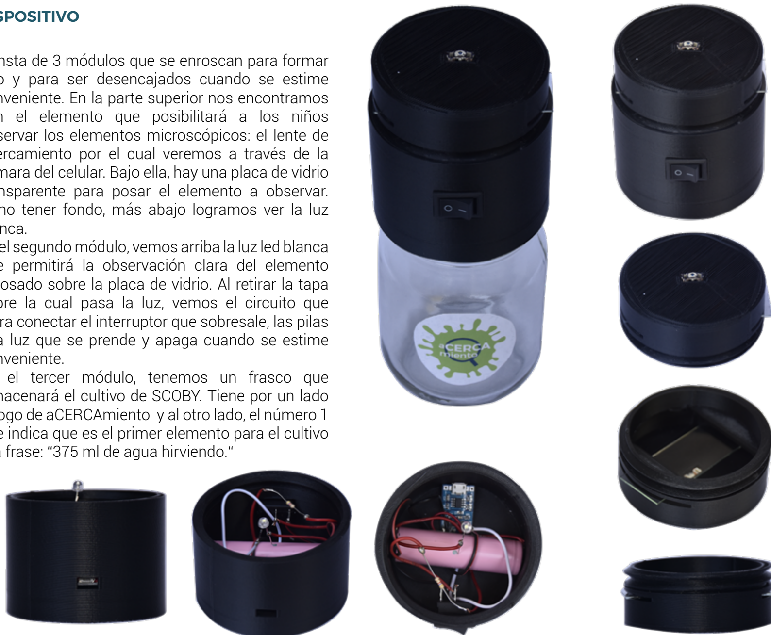
Figura 96-103: Dispositivo de Proyecto aCERCAMIENTO Fuente: Elaboración propia (2020).
