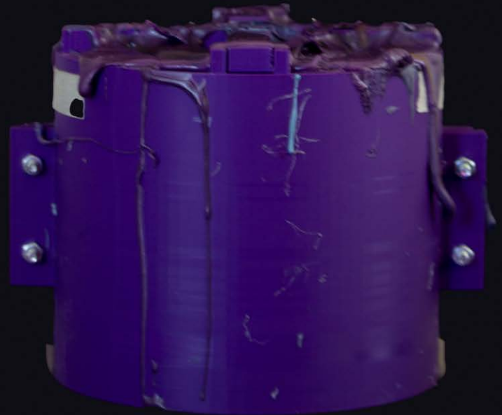
Contramoldes impresos en 3D para generar el producto.
