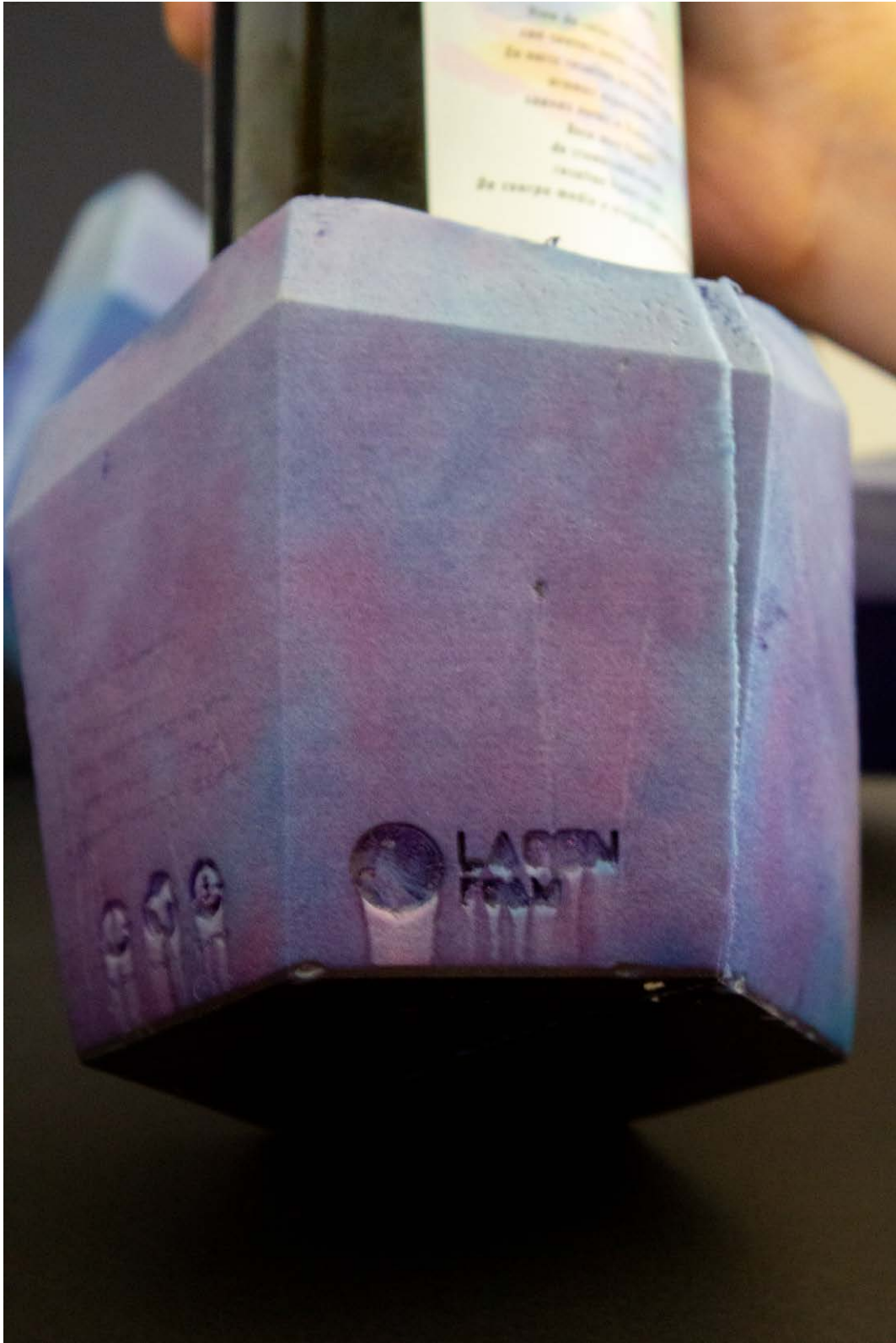
Ejemplo de la baja definición del logo debido al tamaño de este en el contramolde utilizado
