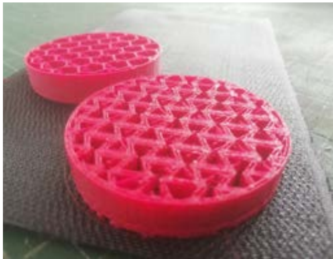
Figura 16 Prueba de impresión en Maker-Bot
