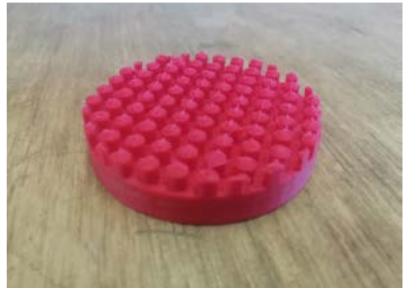
Figura 17 Velcro impreso en 3D
