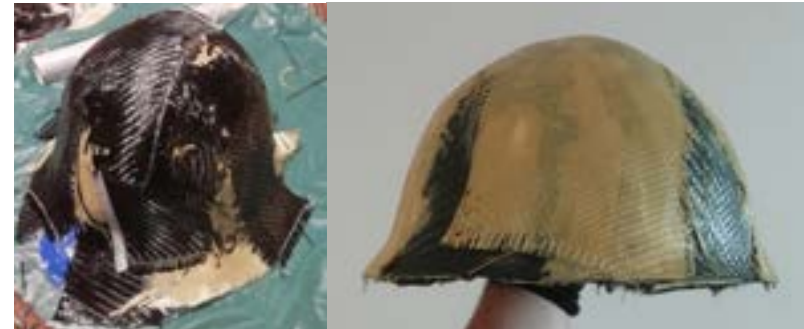
Figura 20 Craneo moldeado a partir de un casco de seguridad
