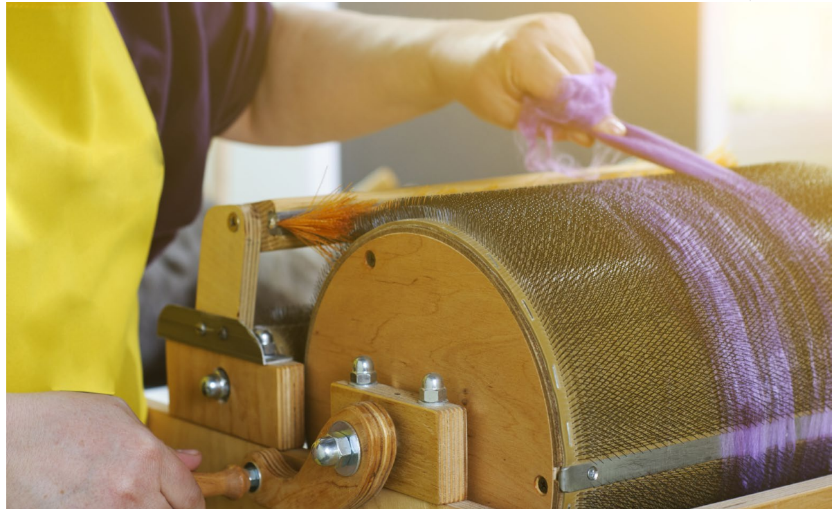
Imagen 36 · Fotografía referencial de una cardadora manual.
