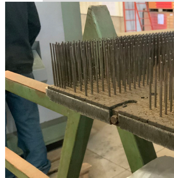
Imagen 32 · Matriz de agujas para punzonado, Geotex.
