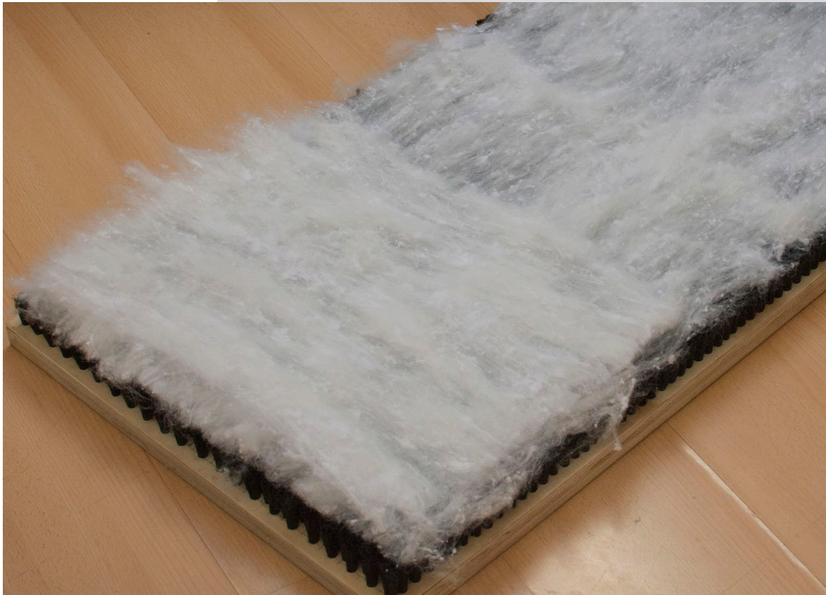
Imagen 38 · Formación del manto sobre el cepillo base.
