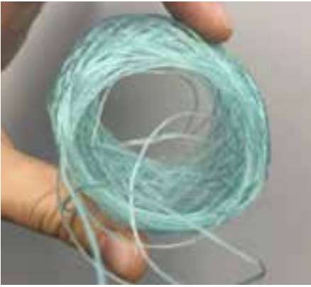
Fibra de alginato extruida en un baño de cloruro de calcio
