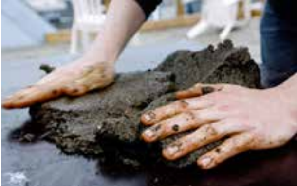
FIG.9 - TERROIR PROJECT MATERIAL LOCAL HECHO A PARTIR DE ALGAS PARDAS Y PAPEL RECICLADO - JONAS EDVARD & NICOLAS STEENFAT DINAMARCA, 2015
