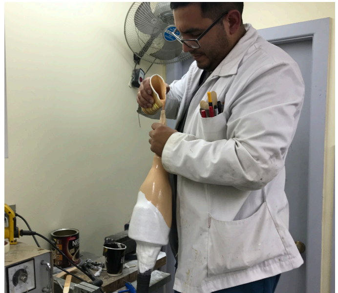
Foto de aplicación de resina sobre molde. Elaboración propia
