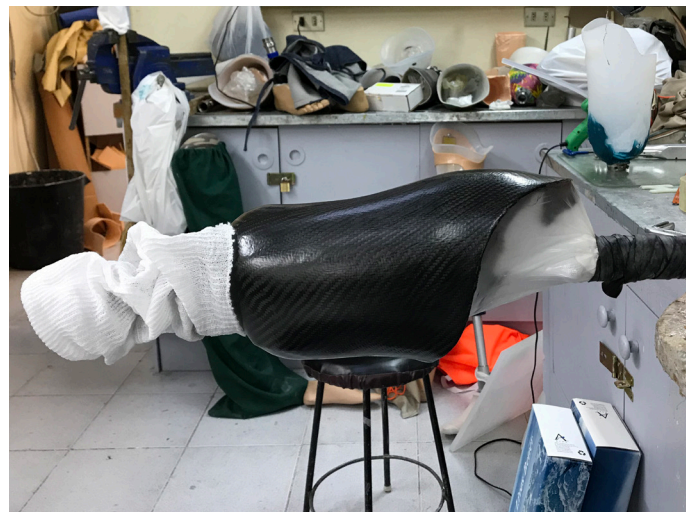
Foto de cavidad de resina listo para extracción. Elaboración propia
