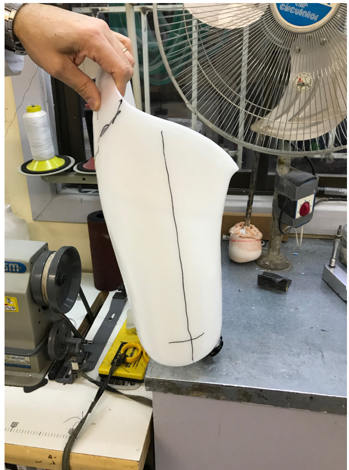
Foto de un socket de prueba, fabricado en polipropileno. Elaboración propia
