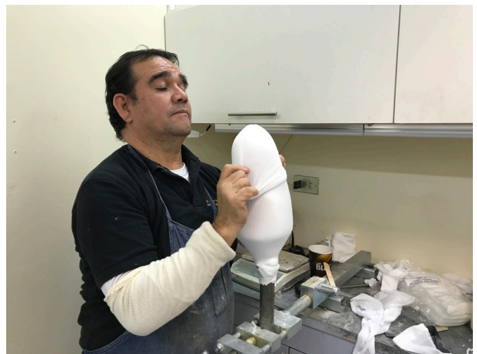
Foto de aplicación de medias para preparación de resina Elaboración propia
