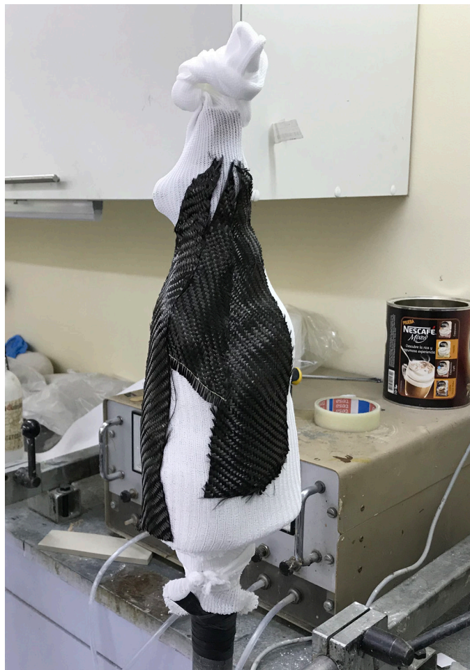
Foto de aplicación de textiles de refuerzo junto con fibra de carbono. Elaboración propia
