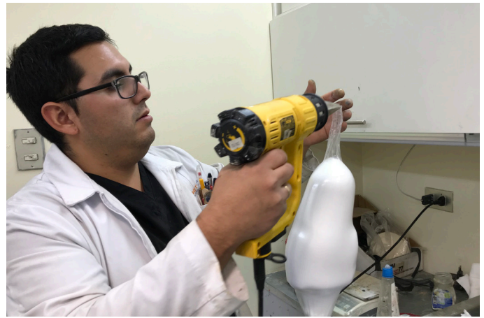
Foto de aplicación de calor para adecuar la bolsa PVA Elaboración propia
