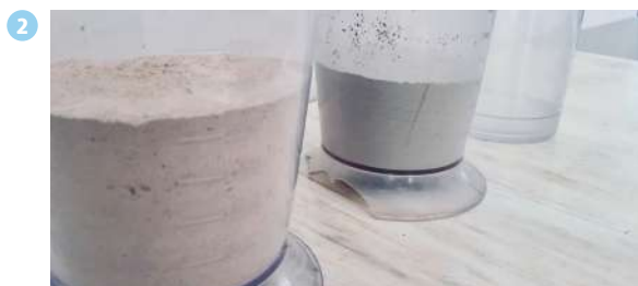
Dosificado: preparar dosis de 60% cal y 40% cemento en las probetas.
