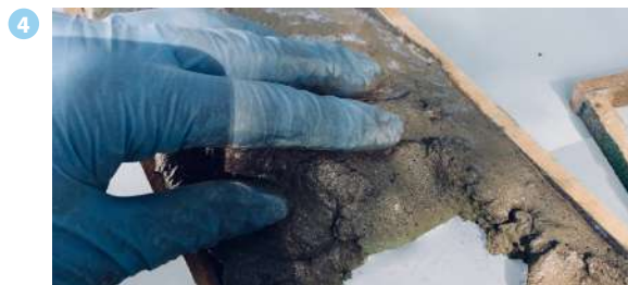
Vaciado: distribuir en el molde hasta que quede liso por completo.
