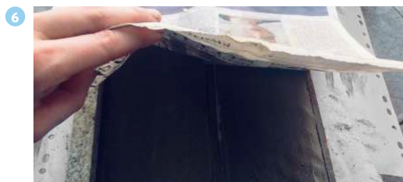
Curado I: tapar con un diario mojado para que la el fraguado se mantenga constantemente hidratado y dejarlo secar por 7 días en un lugar fresco y húmedo.
