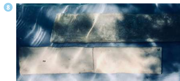
Curado II: dejarlo 7 días más dentro de una recipiente con agua para finalizar su curado.
