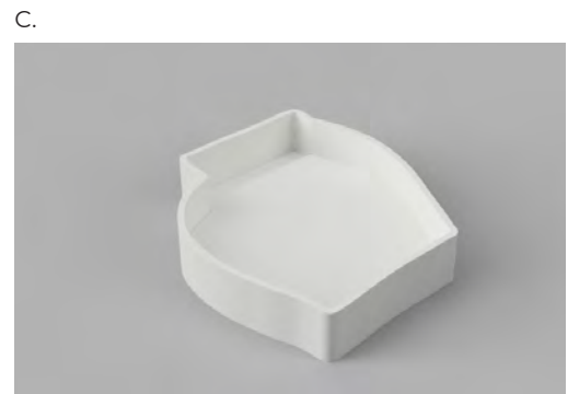
Moldes fabricados en PAI blanco mediante impresión 3D (A) molde costillas, (B) molde cartílago y (C) molde de piel
