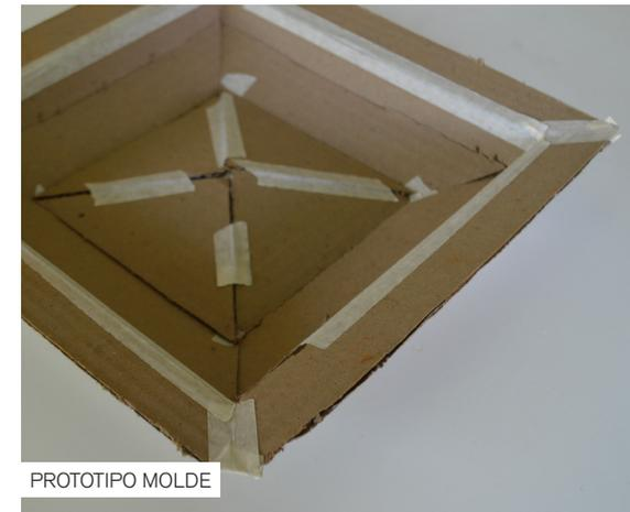
El molde fue pensado en el negativo de la forma del módulo, que al ser simétrico requería fabricar las geometrías principales que conforman la forma para replicarse y unirse entre sí. Se hizo un prototipo rápido en cartón para testear las medidas y ver la factibilidad de hacerlo en hierro. Se definió hacerlo en una lámina de 3 mm de espesor, y con ayuda de los maestros de Schwarz-Haus, lograron hacer puntos pequeños de soldadura sin dañar la geometría propuesta.
