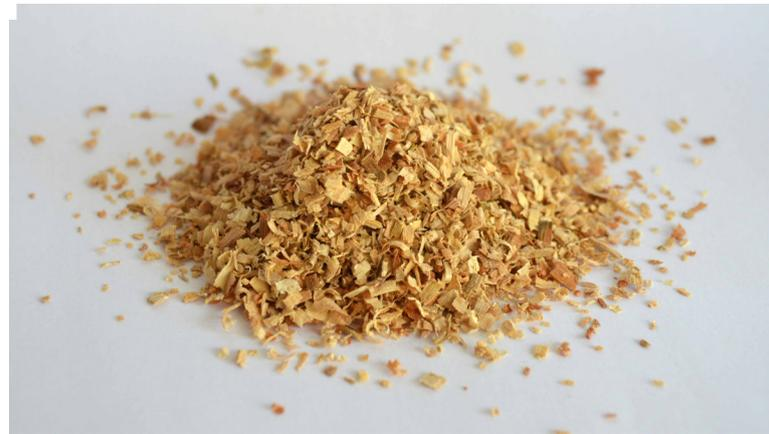
Dado a que se utiliza específicamente el aserrín obtenido de Schwarz-Haus, se decidió trabajar con el aserrín de Eucaliptus Globulus por ser la madera que en mayor cantidad se utiliza en la fábrica, y para limitar las variables en el proceso de experimentación a un tipo de aserrín específico.
