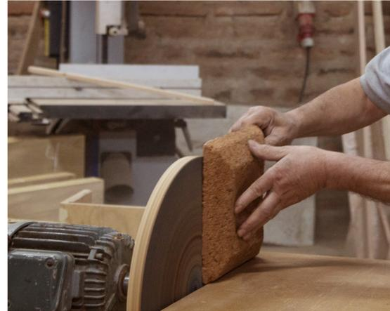
Para testear el adhesivo de contacto se tuvo que lijar la placa para lograr una superficie regular.
