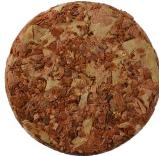
Se utilizaron distintos colorantes naturales, líquidos y en polvo. Ambos se aplicaban previamente al adhesivo, para después ser mezclado con el aserrín. Se obtuvieron mejores resultados con los colorantes en polvo, ya que tenían una mayor concentración de pigmento.
