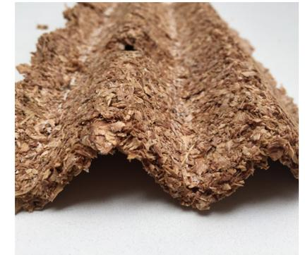
Se hicieron moldes de madera para probar distintas formas en cuanto a curvaturas y pliegues, y se usó una lámina de silicona de cocina entremedio para el desmolde. Se identificó que el material compuesto no adhiere muy bien la forma de pliegues o texturas muy pronunciadas, sino que se moldea mejor a superficies continuas.
